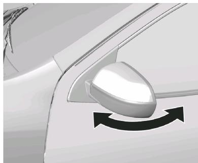
Los retrovisores exteriores se pueden plegar en la dirección mostrada en la ilustración; esta característica está concebida para la protección de los peatones en caso de colisión. Los retrovisores también se pueden plegar manualmente para reducir la anchura total del vehículo y para evitar daños cuando el vehículo está estacionado. Presione sobre el retrovisor para devolverlo a su posición original antes de conducir.
