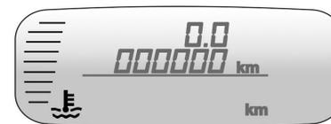
Muestra la temperatura del refrigerante del motor.
