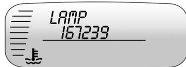
Este mensaje aparece si es necesario sustituir una lámpara de los intermitentes.
