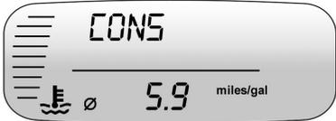
La indicación del consumo medio de combustible muestra la media aproximada de millas por galón (mpg), kilómetros por litro (km/l) o litros por 100 kilómetros (l/100 km).
