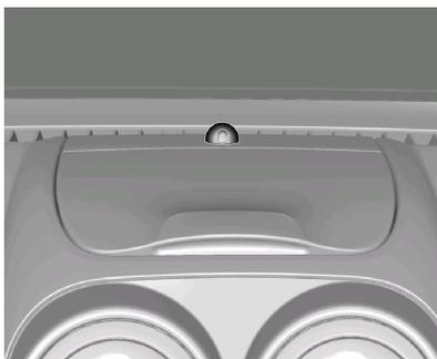
Cuando el sistema de alarma antirrobo está activado, la luz permanece encendida durante 10 segundos y luego empieza a parpadear indicando la activación del sistema.
