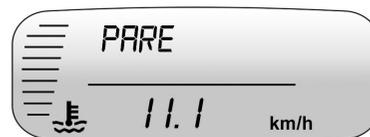
Este mensaje aparece y suena un aviso acústico si el sistema de refrigeración del motor alcanza temperaturas peligrosas para el funcionamiento. Pare el vehículo y apague el motor, tan pronto como sea posible hacerlo con seguridad, para evitar daños graves. Este mensaje se borra cuando el motor se ha enfriado hasta una temperatura de funcionamiento segura.
