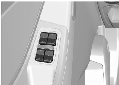
Este sistema se maneja mediante interruptores situados en las puertas respectivas. La disponibilidad para funcionar se indica mediante las luces de los interruptores.
