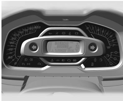
En el cuadro de instrumentos se pueden ver: el velocímetro, el cuentarrevoluciones, el indicador de combustible, la temperatura del refrigerante del motor, los indicadores de los intermitentes y los testigos luminosos.
