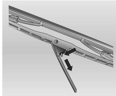
Pulse sobre la lengüeta de bloqueo, empuje la escobilla hacia abajo y desmóntela.
