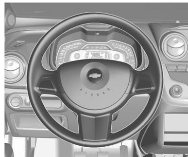
En vehículos equipados con airbag, pulse cualquiera de los puntos
