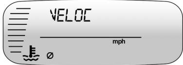
La indicación de velocidad media del vehículo muestra la velocidad media en millas por hora (mph) o kilómetros por hora (km/h).
