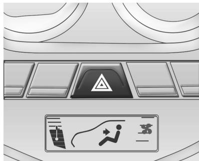
Pulse este botón situado en el tablero de instrumentos, cerca del climatizador automático, para que se enciendan y apaguen los intermitentes delanteros y traseros. Esto sirve para avisar a otros conductores de que tiene una emergencia y se debería usar con el vehículo detenido. Pulse de nuevo para apagar los intermitentes.
