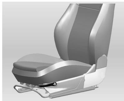
Levante la palanca y no apoye peso en el asiento para subirlo. Tire de la palanca y empuje el asiento hacia
