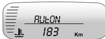
La indicación de autonomía muestra la distancia aproximada que el vehículo puede recorrer sin cargar. La estimación de la autonomía se basa
