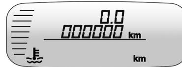
El cuentakilómetros y el cuentakilómetros parcial están situados en la parte superior de la pantalla del cuadro de instrumentos. El cuentakilómetros parcial registra la distancia conducida en un recorrido determinado. Para reiniciarlo, pulse el botón del cuentakilómetros parcial.
