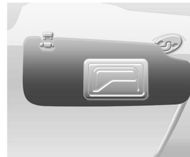
Los parasoles son acolchados y basculan hacia arriba y abajo, o hacia los lados, para evitar el reflejo del conductor y el acompañante. Los dos parasoles están equipados con espejos y un portatarjetas.
