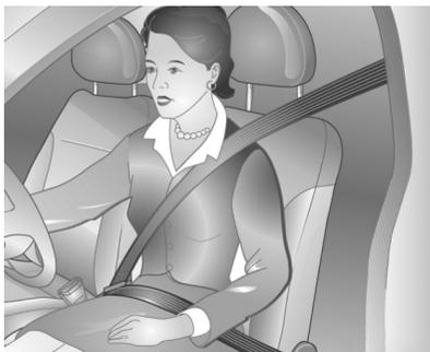
Extraiga el cinturón de seguridad y enlávelo en el cierre. El cinturón de seguridad no debe estar retorcido y debe quedar bien ajustado al cuerpo. El respaldo no debe estar demasiado reclinado.
