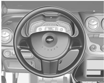
En vehículos equipados con airbag, pulse cualquiera de los puntos
