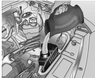
Si no hay señales de fuga, compruebe el funcionamiento del ventilador del motor. Su vehículo está equipado con un ventilador eléctrico. Si hay un sobrecalentamiento del motor, el ventilador debe accionarse. Si el ventilador no actúa, será necesaria su reparación. Apague el motor. Si el problema no está identificado, pero el nivel de refrigerante no está al máximo, añada al depósito de expansión una mezcla de agua potable y aditivo para el radiador ACDelco (de larga
