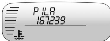
Este mensaje aparece cuando es necesario cambiar la pila del mando a distancia.
