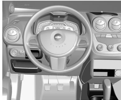
Hay diversos portaobjetos en el tablero de instrumentos, al lado y debajo del botón de la iluminación exterior, así como en la consola central.
