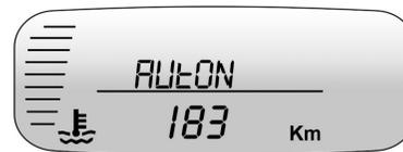
La indicación de autonomía muestra la distancia aproximada que el vehículo puede recorrer sin cargar. La estimación de la autonomía se basa en la media de los consumos de combustible del vehículo en recorridos recientes y la cantidad de combustible que queda en el depósito de combustible. La autonomía se puede reiniciar manteniendo pulsado el botón **R** durante unos 2 segundos.
