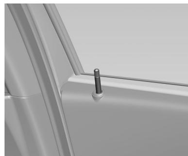
Para accionar el bloqueo de las puertas desde el interior, baje los pestillos de bloqueo. Si la puerta del conductor se bloquea por descuido al cerrar, el pestillo volverá a la posición de desbloqueo. Esto evitará que el vehículo se bloquee con la llave dentro.
