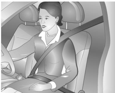
Extraiga el cinturón de seguridad y enclávelo en el cierre. El cinturón de seguridad no debe estar retorcido y debe quedar bien ajustado al cuerpo. El respaldo no debe estar demasiado reclinado.
