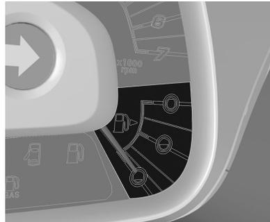
Con el encendido conectado, el indicador de combustible muestra cuánto combustible queda en el depósito de
