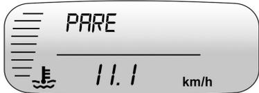
Este mensaje aparece y suena un aviso acústico si el sistema de refrigeración del motor alcanza temperaturas peligrosas para el funcionamiento. Pare el vehículo y apague el motor, tan pronto como sea posible hacerlo con seguridad, para evitar daños graves. Este mensaje se borra cuando el motor se ha enfriado hasta una temperatura de funcionamiento segura.
