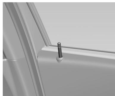
En vehículos sin cierre centralizado, las puertas se pueden bloquear individualmente con el pestillo estando la puerta abierta o cerrada, excepto la puerta del conductor, que sólo se puede bloquear con el pestillo si está cerrada, para evitar que se olvide la llave en el interior del vehículo.
