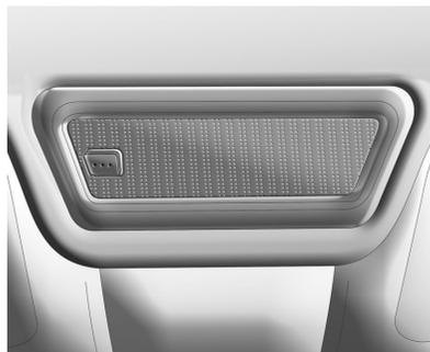
La luz se encenderá automáticamente al abrir cualquier puerta y se apagará poco después de cerrar las puertas. Si quiere apagar la luz con la puerta abierta, pulse el botón que hay
