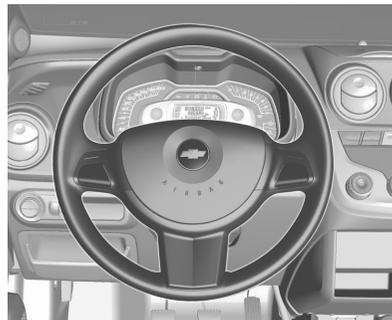
En vehículos equipados con airbag, pulse cualquiera de los puntos
