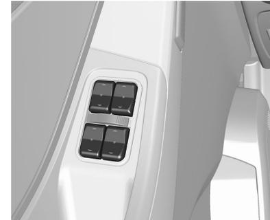
Este sistema se maneja mediante interruptores situados en las puertas respectivas. La disponibilidad para funcionar se indica mediante las luces de los interruptores.
