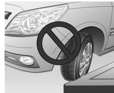
Los impactos contra los bordes de las aceras pueden causar daños internos en llantas y neumáticos. Hay riesgo de accidentes a alta velocidad debido a daños ocultos en los neumáticos, no visibles por fuera, que sólo se notan posteriormente. Por lo tanto, si es necesario subir un borde, hágalo despacio y en ángulo recto si fuera posible.
