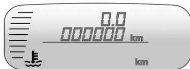
Muestra la temperatura del refrigerante del motor.
