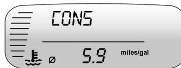
La indicación del consumo medio de combustible muestra la media aproximada de millas por galón (mpg), kilómetros por litro (km/l) o litros por 100 kilómetros (l/100 km).
