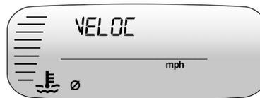
La indicación de velocidad media del vehículo muestra la velocidad media en millas por hora (mph) o kilómetros por hora (km/h).
