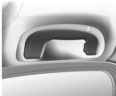
El asidero de seguridad está fijado en el techo, por encima de la puerta del acompañante y de las puertas traseras. Para usarlo, tire hacia abajo; vuelve automáticamente a su posición original después de su uso.
