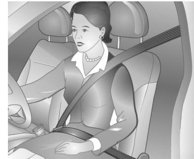
Los cinturones de seguridad son uno de los dispositivos de seguridad más importantes para el conductor y sus pasajeros. Nunca viaje sin usar los cinturones de seguridad. Antes de arrancar el vehículo, tire suavemente del cinturón de seguridad y abróchelo. Al abrocharse, el cinturón no debe estar retorcido. Además de no estar retorcido, la parte superior del cinturón debe quedar apoyada sobre su cuerpo. El respaldo no debería
