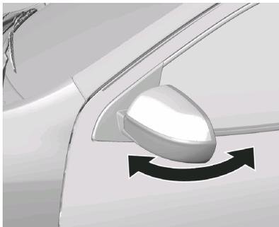
Los retrovisores exteriores se pueden plegar en la dirección mostrada en la ilustración; esta característica está concebida para la protección de los peatones en caso de colisión. Los retrovisores también se pueden plegar manualmente para reducir la anchura total del vehículo y para evitar daños cuando el vehículo está estacionado.
