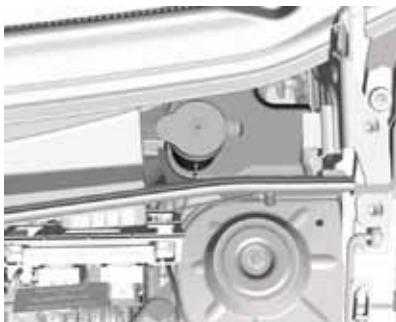
El depósito de líquido del sistema lavaparabrisas está situado en el lado izquierdo del compartimiento del motor. El volumen del depósito es de 2,6 litros aproximadamente. Para una limpieza eficiente, se recomienda añadir un aditivo limpiacristales al agua.
