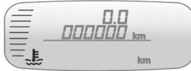
Muestra la temperatura del refrigerante del motor.
