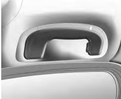
El asidero de seguridad está fijado al techo arriba de la puerta del acompañante y las puertas traseras. Para usarlo, tire hacia abajo; vuelve automáticamente a su posición original después de su uso.
