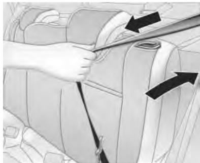
Recline el respaldo hacia atrás a la posición de bloqueo. En el caso del respaldo dividido, se bloquea en la primera posición de ajuste. Presione el botón de liberación para reclinarlo a la posición deseada. En este procedimiento inverso, asegúrese de que el cinturón de seguridad no quede ubicado detrás del respaldo.
