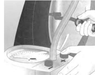
El incremento de presión debido al calentamiento de los neumáticos después de un viaje es normal y no debe reducirse. Después de comprobar la presión de los neumáticos, vuelva a colocar los tapones protectores de las válvulas de inflado.
