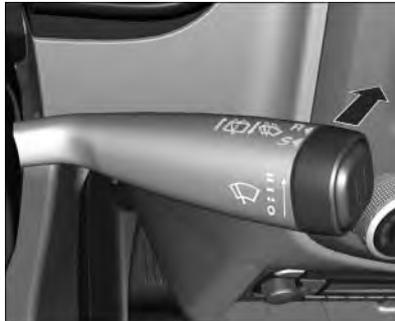
Sólo funciona con el encendido conectado. El limpiaventana y lavaluneta trasera funciona en cualquiera de las dos posiciones de la palanca.
