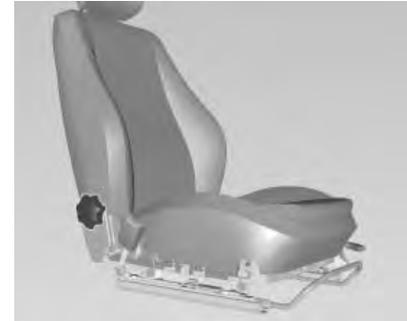
Para ajustar el respaldo, utilice el mando giratorio en la parte lateral del asiento. No se apoye en el respaldo mientras lo ajusta.
