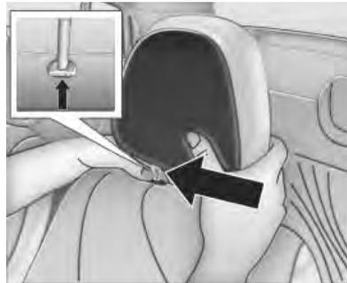
Pulse el botón de desbloqueo (flecha), ajuste la altura y enclave.
