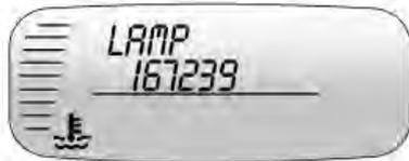
Este mensaje aparece si es necesario sustituir una lámpara de los intermitentes.
