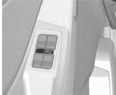
El interruptor está ubicado entre los interruptores de las ventanillas eléctricas ubicados del lado izquierdo del conductor. A la izquierda (superficie roja visible) – las ventanillas traseras no se pueden accionar con los interruptores de las puertas traseras. A la derecha (superficie verde visible) – las ventanillas
