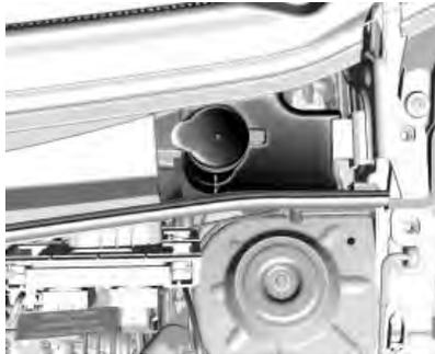
El depósito de líquido del sistema lavaparabrisas está situado en el lado izquierdo del compartimento del motor. El volumen del depósito es de 2,6 litros aproximadamente. Para una limpieza eficiente, se recomienda añadir un aditivo limpiacristales al agua.
