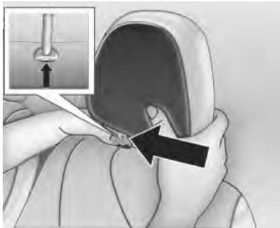
Para ajustar el apoyacabezas, pulse el botón de desbloqueo (flecha) y suba o baje el apoyacabezas con la mano. El apoyacabezas se puede colocar en tres alturas diferentes.
