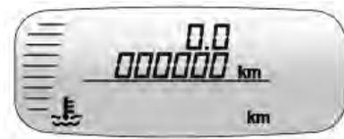
El cuentakilómetros y el cuentakilómetros parcial están situados en la parte superior de la pantalla del cuadro de instrumentos. El cuentakilómetros parcial registra la distancia conducida en un recorrido determinado. Para reiniciarlo, pulse el botón del tablero de instrumentos cuando se muestre el cuentakilómetros parcial.
