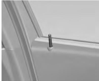
En los vehículos sin sistema de cierre centralizado, las puertas se pueden bloquear individualmente con el "pestillo" estando la puerta abierta o cerrada, excepto la puerta del conductor, que sólo se puede bloquear con el pestillo si la misma está cerrada, para evitar el olvido de la llave dentro del vehículo.
