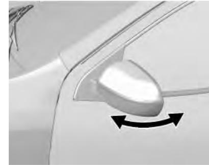
Los espejos retrovisores exteriores se pueden plegar en la dirección mostrada en la ilustración. Esta característica está diseñada para protección de los peatones en caso de accidente. Los espejos también
