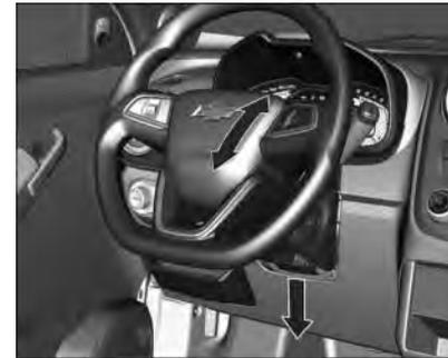
Desbloquee la palanca, ajuste el volante, luego bloquéela de nuevo y asegúrese de que esté totalmente bloqueada.
