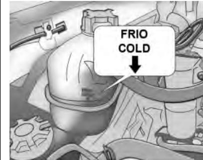
En raras ocasiones se producen pérdidas en un sistema de refrigeración de circuito cerrado. Por ello, casi nunca se requiere llenarlo hasta el nivel, pero se debe comprobar semanalmente con el vehículo en una superficie plana y el motor frío.
