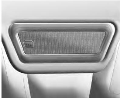
La luz se encenderá automáticamente al abrir cualquier puerta y se apagará poco después de cerrar las puertas. Si quiere apagar la luz con la puerta abierta, pulse el botón que hay en la
