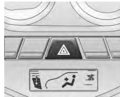
Pulse este botón situado en el tablero de instrumentos, cerca del climatizador automático, para que se enciendan y apaguen los intermitentes delanteros y traseros. Esto sirve para avisar a otros conductores de que tiene una
