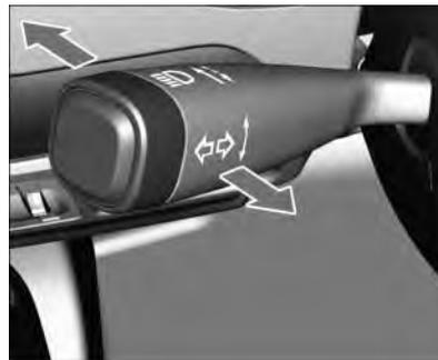
**Señales con luz alta:** Tire de la palanca
