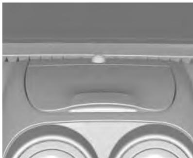
El sensor de luz está situado en la parte superior del tablero de instrumentos y permite encender / apagar la luz baja cuando el conmutador de las luces está en el modo AUTO.
