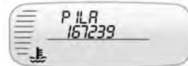
Este mensaje aparece cuando es necesario cambiar la pila del mando a distancia.
