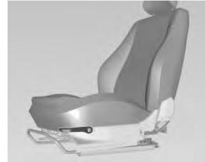
Levante la palanca y no apoye peso sobre el asiento para subirlo. Tire de la palanca y empuje el asiento hacia abajo para bajarlo. Ajuste la banqueta de asiento según la altura del conductor para llegar bien a los pedales y al volante.
