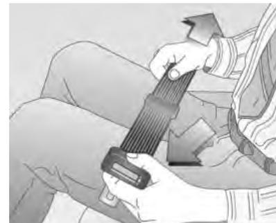
El pasajero que se sienta en la posición central debe usar un cinturón de seguridad de cadera abrochado correctamente.
