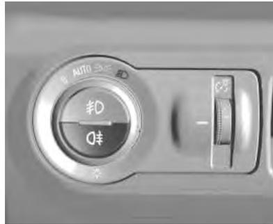
En vehículos equipados con faros antiniebla traseros, el botón está situado en el control de las luces exteriores, en el lado exterior del tablero de instrumentos.
