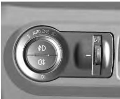
**En vehículos con faros antiniebla delanteros y traseros y control automático de las luces.**
