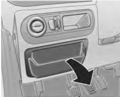
La caja de fusibles y el bloque de relés están situados debajo del tablero de instrumentos; para acceder, tire del portaobjetos como se muestra en la ilustración.
