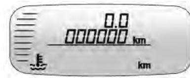
Muestra la temperatura del refrigerante del motor.
