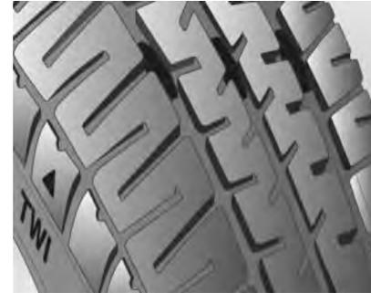
Por motivos de seguridad, los neumáticos deberían sustituirse cuando la profundidad del dibujo se haya desgastado hasta cerca de 3 mm.
