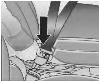
6. Para desabrocharse el cinturón, pulse el botón del cierre. El cinturón se recoge automáticamente.
