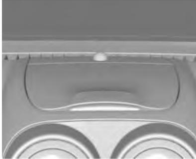
Cuando está activado el sistema antirrobo, la luz queda encendida durante unos 10 segundos y comienza a destellar indicando la activación del sistema.
