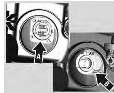
3. Desmonte la lámpara con el conector (A), tirando del casquillo hacia la parte posterior del faro.
