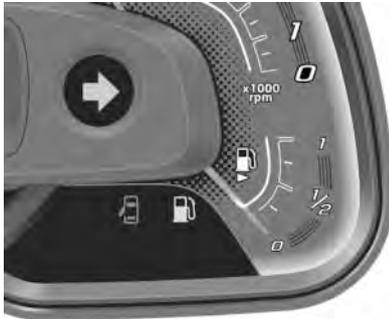
Con el encendido conectado, el indicador de combustible muestra cuánto combustible queda en el depósito de combustible del vehículo. Una flecha en el indicador de combustible señala en qué lado del vehículo está la tapa del depósito. El indicador señala vacío antes de que el vehículo agote el combustible para avisar de que debería llenar pronto el depósito de combustible del vehículo.
