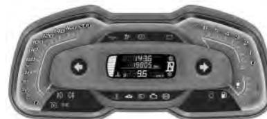
En el cuadro de instrumentos se pueden ver: el velocímetro, el cuentarrevoluciones, el indicador de combustible, la temperatura del refrigerante del motor, los indicadores de los intermitentes y los indicadores luminosos.
