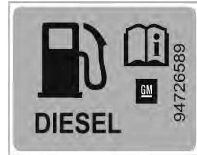
La etiqueta adhesiva mostrada arriba indica el tipo de combustible y está situada en la tapa del depósito de combustible del vehículo.
