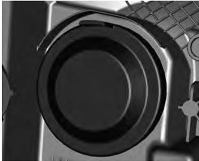
2. Retire el protector de la lámpara del faro tirando de la lengüeta.
