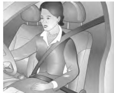
Los cinturones de seguridad son uno de los dispositivos de seguridad más importantes para el conductor y sus pasajeros. Nunca viaje sin usar los cinturones de seguridad. Antes de arrancar el vehículo, tire suavemente del cinturón de seguridad y abrócheselo. Al abrocharse, el cinturón no debe estar retorcido. Además de no estar retorcido, la parte superior del cinturón debe quedar apoyada
