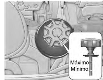
Compruebe el nivel de líquido de la dirección asistida con el motor apagado.
