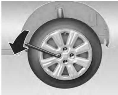
7. Con la llave para tornillos de rueda, afloje los tornillos de rueda de 1/2 a 1 vuelta sin desmontarlos.
