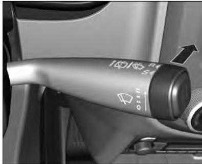
Sólo funciona con el encendido conectado. El limpialuneta y lavaluneta trasera funciona en cualquiera de las dos posiciones de la palanca.
