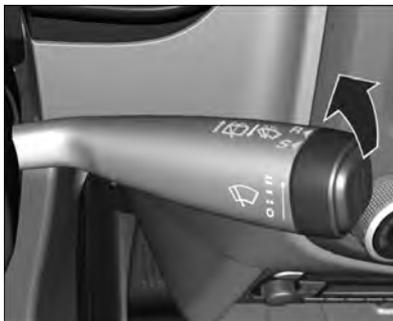
La palanca de accionamiento de los limpiaparabrisas tiene cuatro posiciones:
