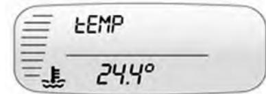
La indicación de temperatura del aire exterior muestra la temperatura del aire ambiente exterior.
