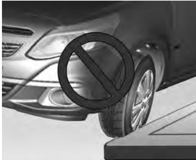
Los impactos contra los bordes de las aceras pueden causar daños internos en cubiertas y neumáticos. Hay riesgo de accidentes a alta velocidad debido a daños ocultos en los neumáticos, no visibles externamente. Por lo tanto, si es necesario subir un borde, hágalo despacio y en ángulo recto si fuera posible.
