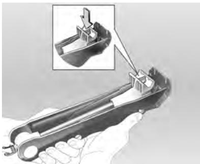
9. Coloque el brazo del gato en el punto de aplicación más cercano a la rueda que va a sustituir. La garra del gato (flecha) debe abarcar el refuerzo vertical y debe encajar en el rebaje del mismo.
