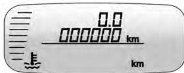
Muestra la temperatura del refrigerante del motor.
