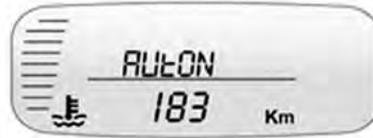
La indicación de autonomía muestra la distancia aproximada que el vehículo puede recorrer sin cargar. La estimación de la autonomía se basa en la media de los consumos de combustible del vehículo en recorridos recientes y la cantidad de combustible que queda en el depósito de combustible. La autonomía se puede reiniciar manteniendo pulsado el botón **R** durante aproximadamente 2 segundos.
