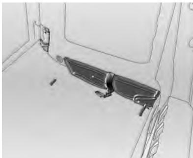
El triángulo de advertencia se guarda en panel del lado derecho del compartimento de equipaje.
