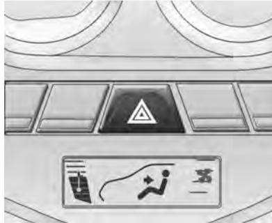
Pulse este botón situado en el tablero de instrumentos, cerca del climatizador automático, para que se enciendan y apaguen los intermitentes delanteros y traseros. Esto sirve para avisar a otros conductores de que tiene una emergencia y se debería usar con el vehículo detenido. Presiónelo nuevamente para apagar las balizas.
