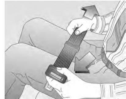
El pasajero que se sienta en la posición central debe usar un cinturón de seguridad de cadera abrochado correctamente.
