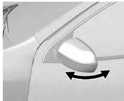
Los espejos retrovisores exteriores se pueden plegar en la dirección mostrada en la ilustración. Esta característica está diseñada para protección de los peatones en caso de accidente. Los espejos también se pueden plegar manualmente para reducir el ancho total del vehículo y también para evitar daños cuando se estaciona el mismo.
