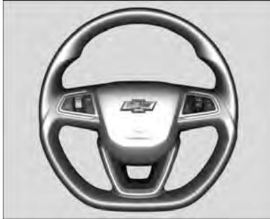
Este sistema se identifica mediante la inscripción "Airbag" en el volante (lado del conductor) y encima de la guantera (lado del acompañante); además, hay una etiqueta adhesiva en el lateral de la puerta del conductor.
