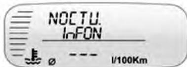
Para seleccionar el modo nocturno, mantenga pulsados a la vez los botones **R** y **S** hasta que aparezca el modo nocturno en la pantalla. Pulsando el botón **R** puede activar o desactivar la función.
