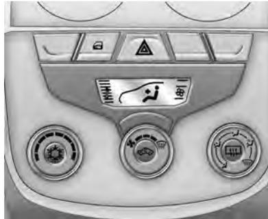
Además del flujo de aire natural que entra en el vehículo por las entradas de aire del panel delantero cuando el vehículo está en marcha, también se puede accionar un ventilador para incrementar el caudal de aire. Para un mayor confort, este aire se puede calentar o refrigerar (con el aire acondicionado).
