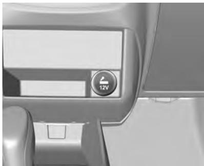
Con el encendedor conectado, pulse sobre el encendedor y espere unos segundos, éste volverá automáticamente a su posición listo para su uso. La toma para la conexión del encendedor se puede usar para conectar accesorios eléctricos de 12 V.
