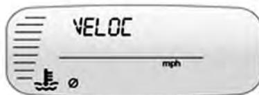
La indicación de velocidad media del vehículo muestra la velocidad media en millas por hora (mph) o kilómetros por hora (km/h).
