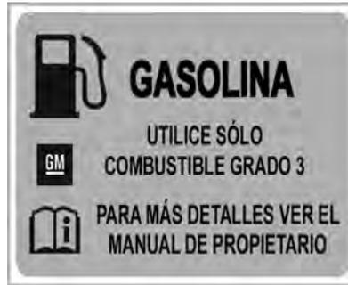
La etiqueta adhesiva mostrada arriba indica el tipo de combustible y está situada en la tapa del depósito de combustible del vehículo.
