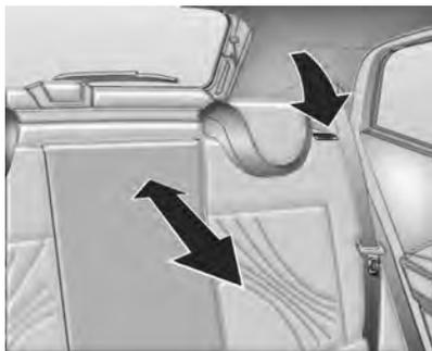
El respaldo del asiento trasero se puede bloquear en varias posiciones. Para ajustarlo, presione el botón de liberación y coloque el respaldo en la posición deseada.
