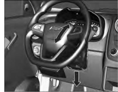
Desbloquee la palanca, ajuste el volante, luego bloquéela de nuevo y asegúrese de que esté totalmente bloqueada.
