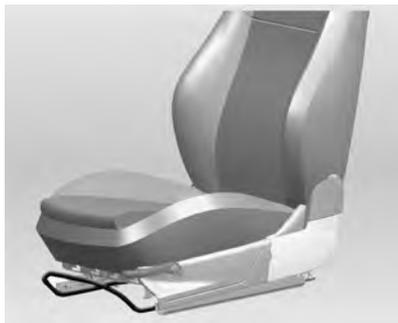
Para ajustar el asiento hacia delante / hacia atrás, levante la palanca de mando, deslice el asiento hasta la posición deseada y suelte la palanca para enclavar el asiento en dicha posición.
