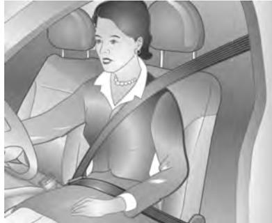
Extraiga el cinturón de seguridad y abroche la hebilla en el cierre. El cinturón de seguridad no debe estar retorcido y debe quedar bien ajustado al cuerpo. El respaldo no debe estar demasiado reclinado. Para soltar el cinturón, pulse el botón rojo del cierre de la hebilla.
