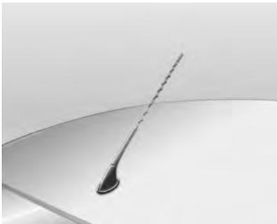
La antena de la radio está situada en la parte delantera del techo. Para desmontarla, gírela en sentido antihorario. Para montar la antena, gírela en sentido horario.
