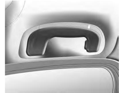
El asidero de seguridad está fijado al techo arriba de la puerta del acompañante y las puertas traseras. Para usarlo, tire hacia abajo; vuelve automáticamente a su posición original después de su uso.
