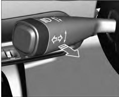
Se usan para enviar señales luminosas con la luz alta. Para ello, tire de la palanca hacia el volante. Las señales con luz alta se pueden accionar mientras los intermitentes están funcionando.
