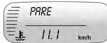
Este mensaje aparece y suena un aviso acústico si el sistema de refrigeración del motor alcanza temperaturas peligrosas para el funcionamiento. Pare el vehículo y apague el motor, tan pronto como sea posible hacerlo con seguridad, para evitar daños graves. Este mensaje se borra cuando el motor se ha enfriado hasta una temperatura de funcionamiento segura.
