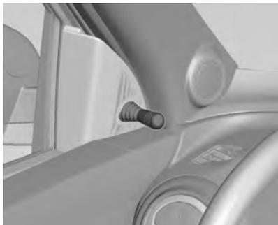
Los espejos retrovisores exteriores se pueden ajustar fácilmente mediante palancas de ajuste del vehículo. Para realizar el ajuste de posición, mueva la palanca ajustadora instalada en el panel de la puerta.
