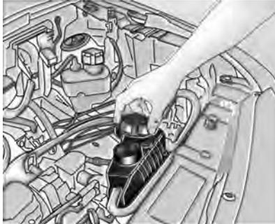
El sistema de refrigeración del motor se llena con un aditivo de larga duración para el radiador (glicol etileno) cuyas propiedades ofrecen una protección adecuada contra la congelación, ebullición y corrosión.
