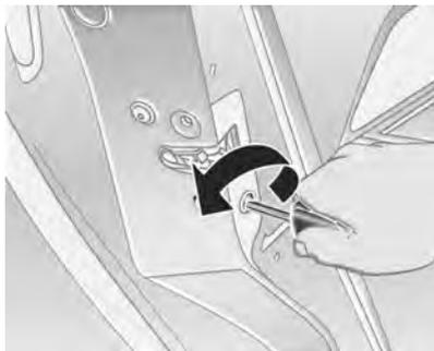
Para evitar abrir las puertas desde el interior del vehículo, existen cerraduras de seguridad extra ubicadas debajo de la cerradura de las puertas traseras. Se pueden accionar usando la llave y girando el interruptor en sentido antihorario. Para desactivarlas, gire el interruptor en sentido horario.
