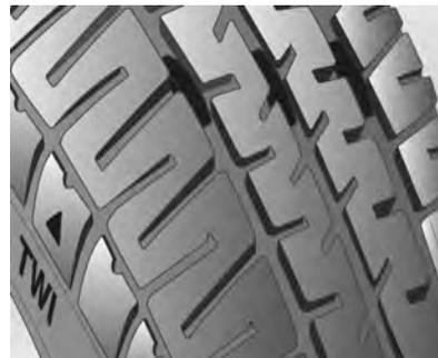
Por motivos de seguridad, los neumáticos deberían sustituirse cuando la profundidad del dibujo se haya desgastado hasta cerca de 3 mm.
