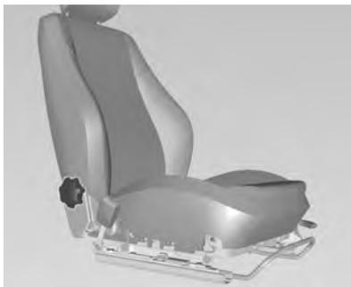
Para ajustar el respaldo, utilice el mando giratorio en la parte lateral del asiento. No se apoye en el respaldo mientras lo ajusta.
