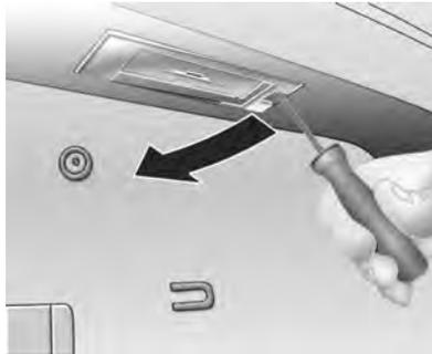
1. Desmonte el portalámparas con un destornillador, ejerciendo presión hacia el lado y hacia abajo (como en la ilustración) hasta que se desenclave.
