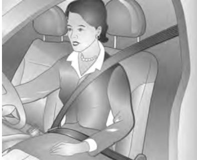
Los cinturones de seguridad son uno de los dispositivos de seguridad más importantes para el conductor y sus pasajeros. Nunca viaje sin usar los cinturones de seguridad. Antes de arrancar el vehículo, tire suavemente del cinturón de seguridad y abrócheselo. Al abrocharse, el cinturón no debe estar retorcido. Además de no estar retorcido, la parte superior del cinturón debe quedar apoyada sobre su cuerpo. El respaldo no debería estar demasiado inclinado
