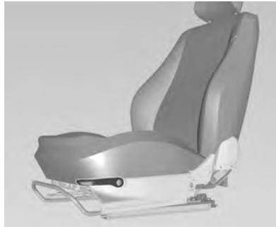
Levante la palanca y no apoye peso sobre el asiento para subirlo. Tire de la palanca y empuje el asiento hacia abajo para bajarlo. Ajuste la banqueta de asiento según la altura del conductor para llegar bien a los pedales y al volante.
