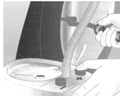
El incremento de presión debido al calentamiento de los neumáticos después de un viaje es normal y no debe reducirse. Después de comprobar la presión de los neumáticos, vuelva a colocar los tapones protectores de las válvulas de inflado.
