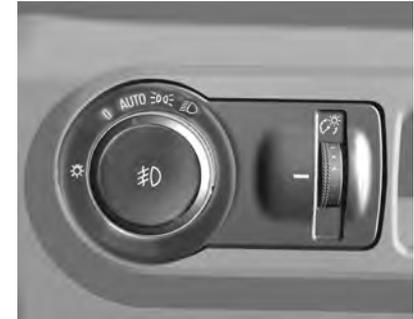
En vehículos con faros antiniebla y control automático de las luces.
