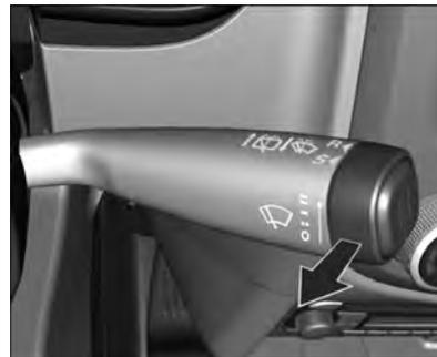
Para activar el sistema de lavaparabrisas, tire de la palanca. Los lavaparabrisas se activarán inmediatamente con el agua del parabrisas.
