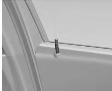
Para accionar las cerraduras de las puertas desde el interior, oprima los pestillos de bloqueo. Si el conductor bloquea las puertas accidentalmente al cerrarlas, la palanca vuelve a la posición de desbloqueo. De esta forma se evita que el vehículo quede bloqueado con la llave adentro.
