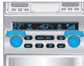
Control electrónico del acondicionador de aire
