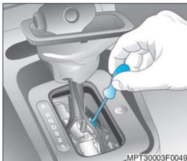
4. Empuje la garra hacia afuera con ayuda de un destornillador y mueva la palanca selectora hacia una posición que no sea la posición **P**.
