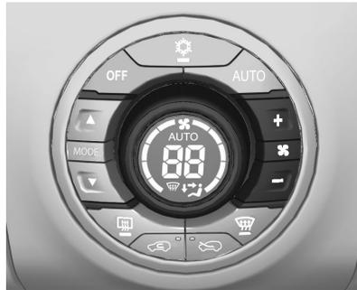
Pulse el botón + o el botón - para aumentar o reducir, respectivamente, la velocidad del ventilador. La velocidad del ventilador seleccionada se indica mediante las barras en la pantalla.
