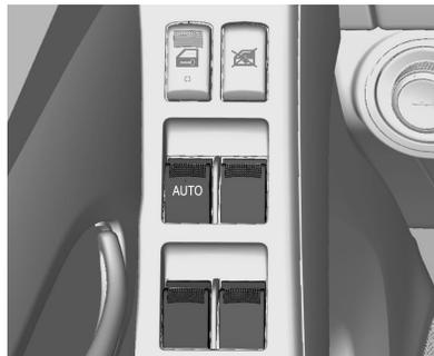
Accione el interruptor de la ventanilla correspondiente: pulse para abrir o tire para cerrar. El interruptor de la ventanilla del conductor tiene una luz que, al iluminarse, señala que está operativo.
