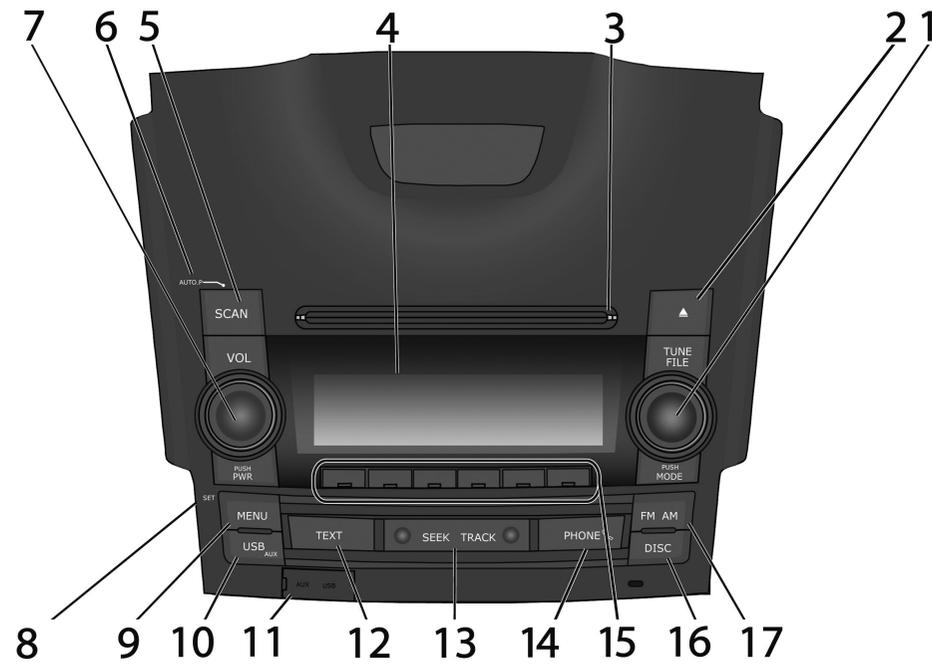
**Tipo 1:** Radio doble DIN + CD/MP3 + AUX + USB + Bluetooth®
