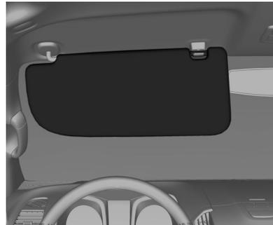
Los parasoles se pueden abatir o bascular hacia un lado para evitar el deslumbramiento.
