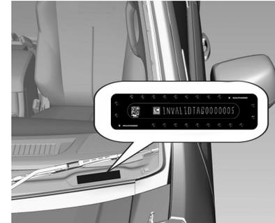
El número de identificación del vehículo está estampado en el tablero de instrumentos, visible a través del parabrisas.
