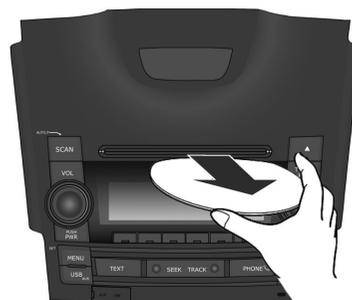
Para expulsar el disco, pulse el botón de **expulsión**  $\triangle$  y retire el disco.
