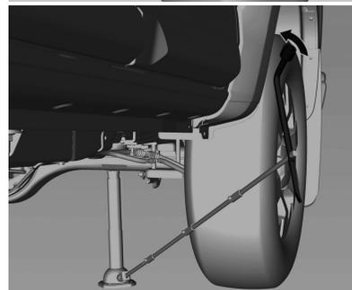
Si el neumático pinchado está en la parte trasera, coloque el gato debajo del eje trasero y lo más cerca posible del amortiguador.
