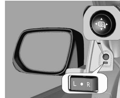
Mueva el interruptor selector hacia la posición **L** (izquierda) o **R** (derecha) para elegir el retrovisor del conductor o del acompañante. Mueva el retrovisor en la dirección deseada pulsando el conmutador de cuatro posiciones.
