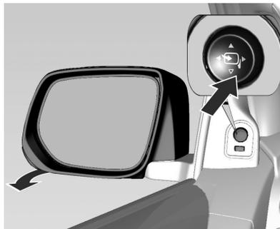
Coloque el selector (interruptor L / R) en la posición central ●, luego pulse el conmutador de cuatro posiciones hacia abajo. Se plegarán los dos retrovisores exteriores.
