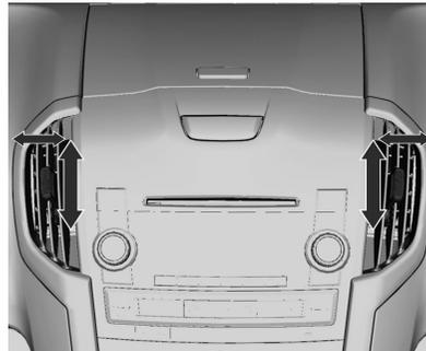
Mueva la aleta hacia arriba para abrir y hacia abajo para cerrar la salida de aire o para ajustar el caudal.
