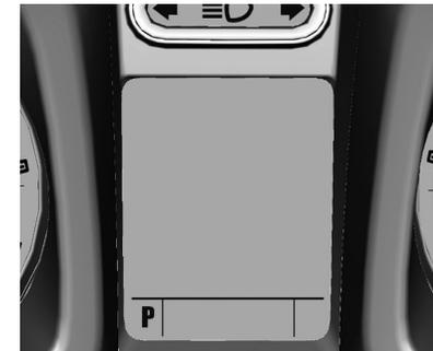
La marcha o el modo seleccionado se muestra en la pantalla central del tablero de instrumentos.
