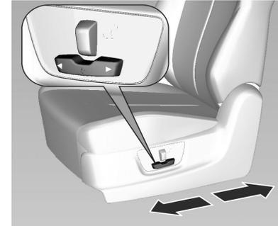
La posición se puede ajustar moviendo el interruptor hacia delante o hacia atrás.
