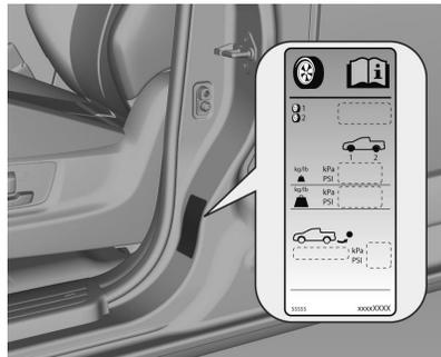
Presión de los neumáticos ⇨ 268 y en la etiqueta colocada en el marco de la puerta delantera derecha.
