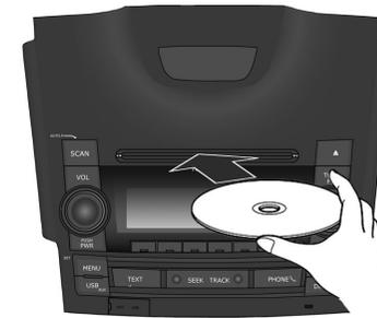
Inserte el disco que se va a reproducir con la superficie impresa hacia arriba en la ranura de inserción del disco.
