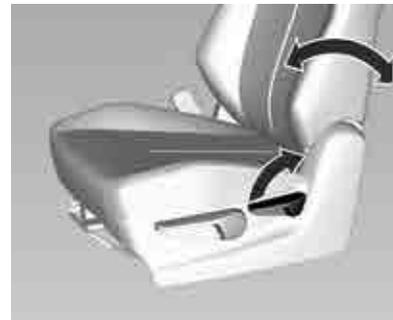
Tire de la palanca, ajuste la inclinación y suelte la palanca. El asiento debería bloquearse en su lugar.
