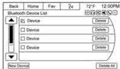
3. Seleccione el dispositivo y pulse el botón de pantalla Delete (Eliminar) asociado con el dispositivo seleccionado.
