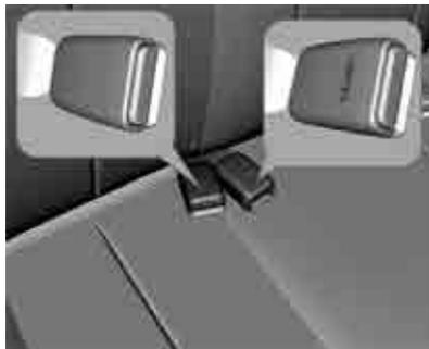
Los ocupantes traseros tienen sus propias hebillas. El ocupante del lado externo debe usar la hebilla sin la marca CENTER, mientras que el ocupante central debe usar la hebilla con la marca CENTER, como se muestra en la ilustración de arriba.
