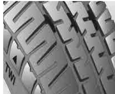
También deben sustituirse los neumáticos cuando la profundidad del dibujo se haya desgastado a un valor cercano a los 3 mm. La imagen muestra dónde se puede ver la profundidad del dibujo.
