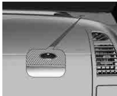
El LED de estado está integrado en el sensor situado en la parte superior del tablero de instrumentos.
