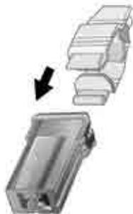
Coloque el extractor de fusibles sobre los diversos tipos de fusible, desde la parte superior o lateral, y extraiga el fusible.
