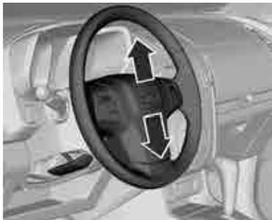
Desbloquee la palanca para ajustar la altura del volante, luego enclave la palanca y asegúrese de que esté totalmente bloqueada. El volante sólo se debe ajustar con el vehículo detenido y la dirección desbloqueada.
