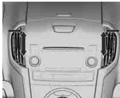
Presione la aleta hacia arriba para abrir y hacia abajo para cerrar la salida de ventilación o ajustar la cantidad de aire.
