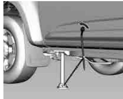
Si el neumático desinflado está en la parte delantera del vehículo, coloque el gato atrás del neumático delantero en el bolsillo del borde del bastidor.
