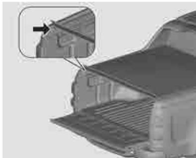
4. Estire la capota sobre el compartimento de carga colocando la barra posterior dentro del riel de soporte lateral, sin trazarla.
