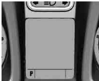
El modo o la marcha seleccionados se muestran en la pantalla central del tablero de instrumentos.
