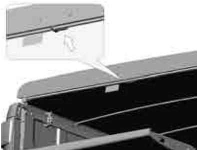
Para abrir la capota, baje el portón trasero y baje la palanca de liberación.
