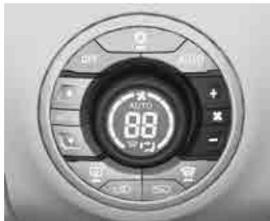
Pulse el botón + o el botón - para aumentar o disminuir la velocidad del ventilador. La velocidad del ventilador seleccionada se indica mediante barras en la pantalla.
