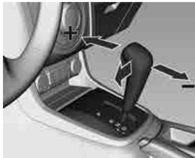
Mueva la palanca de cambios desde la posición **D** hacia la izquierda y luego hacia delante o hacia atrás.
