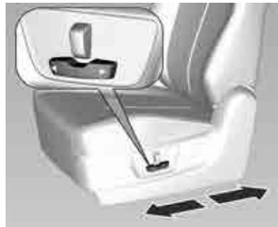
Se puede ajustar la posición moviendo el interruptor hacia adelante o hacia atrás.
