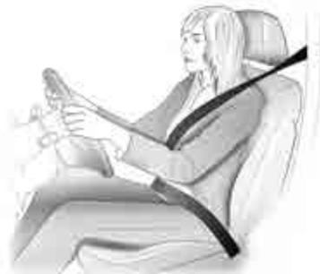
Extraiga el cinturón de seguridad y enlávelo en el cierre. El cinturón de seguridad no debe estar retorcido y debe ser abrochado al cierre, quedando ajustado al cuerpo. El respaldo no debe estar demasiado reclinado (un máximo de 25° aproximadamente).
