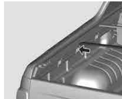
2. Coloque el otro extremo del travesaño trasero en el riel. Alinee los extremos del travesaño con las etiquetas que se encuentran en la parte superior del riel.
