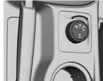
Gire el interruptor de control del cambio para acoplar y desacoplar la tracción en las cuatro ruedas. Puede elegir entre lo siguiente:
