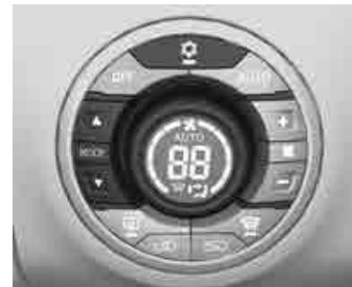
Pulse el botón **MODO** una o más veces para efectuar el ajuste deseado; el ajuste de la distribución de aire se indica en la pantalla de información.
