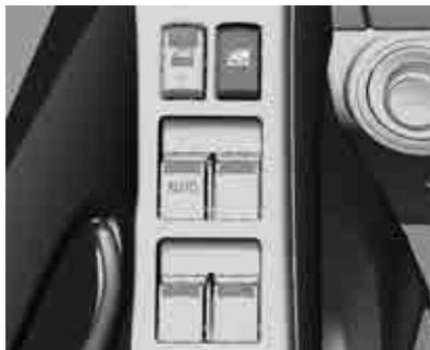
Presione el interruptor
