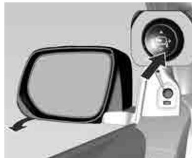
Mueva el interruptor de selección (interruptor L / R) a la posición central ●, luego empuje el interruptor de cuatro direcciones hacia abajo. Se plegarán los dos retrovisores exteriores.
