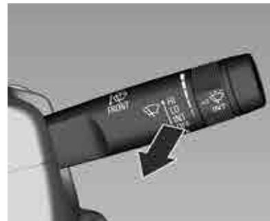
Tire de la palanca. Se pulveriza líquido de lavado sobre el parabrisas y los limpiaparabrisas realizan algunos barridos.
