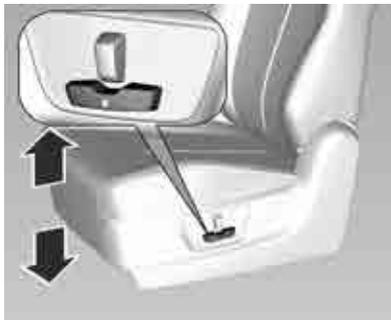
Se puede ajustar la altura moviendo el interruptor hacia arriba o hacia abajo.
