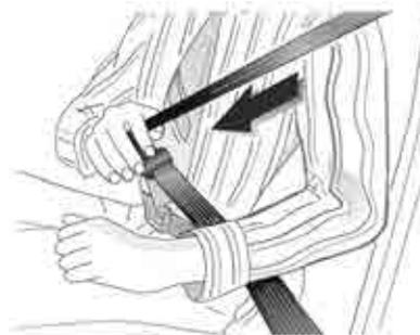
Extraiga el cinturón del retractor, guíelo por encima del cuerpo sin retorcerlo y enclave la lengüeta en el cierre. Durante el viaje, tense frecuentemente el cinturón abdominal tirando suavemente de la banda torácica.
