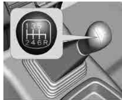
Marcha atrás: con el vehículo estacionario, presione el pedal del embrague.
