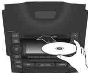
Inserte en la ranura el disco a reproducir con la superficie impresa hacia arriba.
