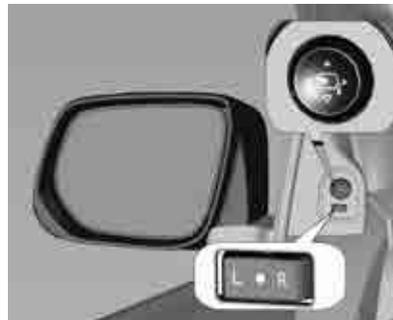
El control para los espejos eléctricos se encuentra en el panel de la puerta al lado del conductor.
