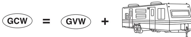
**GCW (Peso bruto combinado):** es el peso del vehículo cargado (GVW) más el peso del remolque totalmente cargado.
