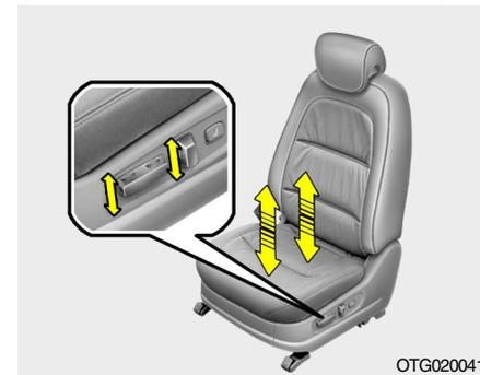
Para subir o bajar la parte delantera del cojín del asiento, mueva la parte delantera de la palanca de control hacia arriba, o hacia abajo. Para subir, o bajar, la parte posterior del cojín del asiento, mueva la parte de atrás de la palanca de control hacia arriba, o hacia abajo.
