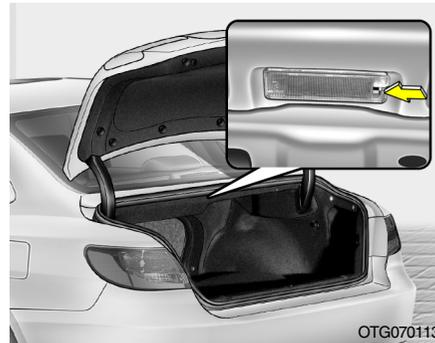
2. Desmonte la cubierta de la luz del compartimento del maletero empujando el mando.
