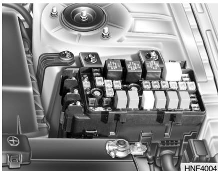
Un fusible puede cortarse debido a una sobrecarga eléctrica. Esto previene que la rama eléctrica se queme. (Esto puede pasar por un exceso de paso de electricidad). Si esto sucede repetidas veces, debe ser revisado por su Servicio HYUNDAI para determinar la causa, reparar el sistema y cambiar el fusible. Los fusibles maestros están en una posición al lado de la batería siendo muy fácil su inspección.
