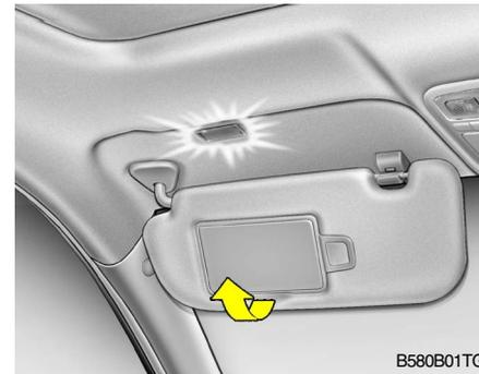
Al abrir la tapa del espejo de cortesía se enciende automáticamente la luz del mismo.
