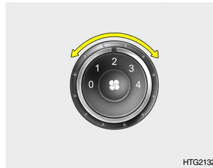
Este se utiliza para conectar o desconectar el ventilador y para seleccionar su velocidad. La velocidad del ventilador y, por lo tanto, el volumen de aire entregado desde el sistema, puede ser controlado manualmente colocando el control del ventilador entre las posiciones "1" y "4".
