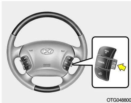
1. Tire sobre el interruptor ON/OFF del control de cruceo. Se iluminará el testigo luminoso "CRUISE" en el panel de instrumento. Con esto se activa el sistema.
