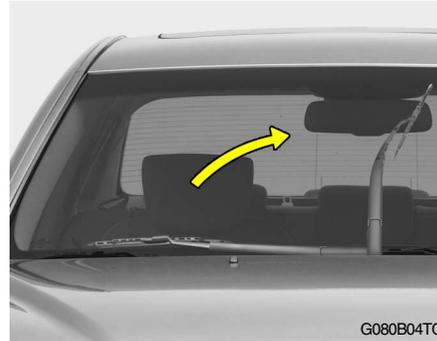
1. Gire el interruptor de encendido a «ON» y sitúe el interruptor del limpiaparabrisas en la posición «LO». Cuando el limpiaparabrisas se encuentre en la posición más alta, gire el interruptor de encendido a «OFF». El limpiaparabrisas se detendrá como se indica en la figura.
