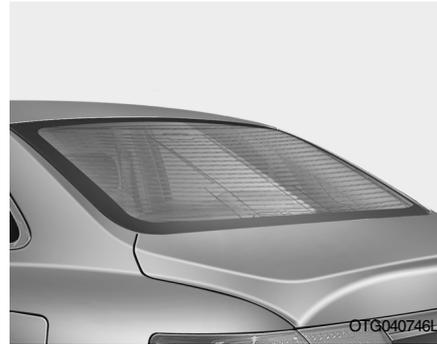
Cuando la radio está activada mientras la llave de contacto se encuentra en la posición "ON" o "ACC", su vehículo recibirá señales de radiodifusión AM y FM a través de la antena instalada en la luna del cristal trasero.
