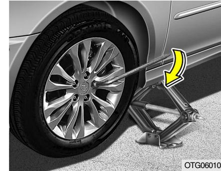
Después ponga la llave como se indica en el figura y apriete los espárragos de la rueda, asegúrese que la llave cubra completamente el perno. No se ponga de pie sobre la herramienta ni use un tubo de extensión en la herramienta. Vaya alrededor de la rueda apretando cada uno de los espárragos hasta que queden todos apretados. Compruebe de nuevo que las tuercas estén bien apretadas.
