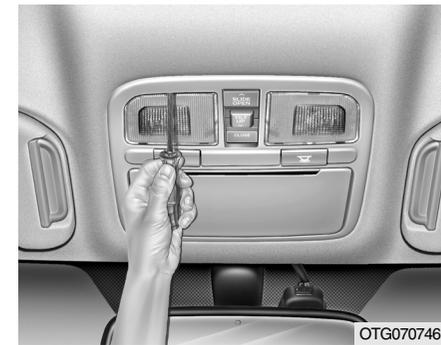
1. Extraiga la tapa de plástico con un destornillador plano.
