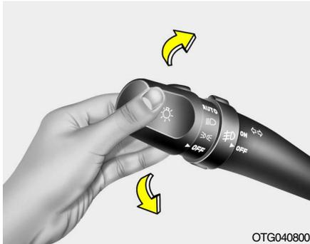
Para utilizar estas luces, tire hacia usted de la palanca del mando señalizador, obteniendo un destello de las luces largas, al soltar la palanca esta volverá automáticamente a la posición central.
