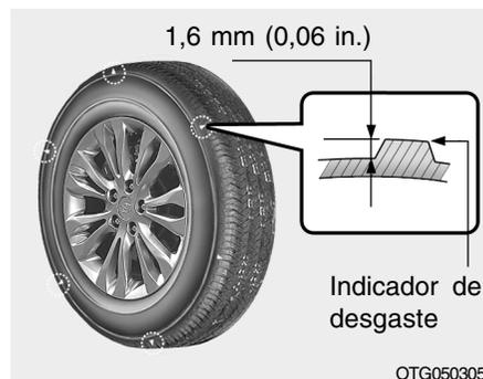
Los neumáticos originales de su automóvil tienen indicadores de desgaste. Estos aparecen cuando la profundidad del dibujo es de 1,6 mm (0,06 in.). Los neumáticos deben ser cambiados cuando aparecen dos o más de los indicadores de desgaste en la superficie. Siempre cambie los neumáticos por los de las medidas recomendadas. Si usted cambia las ruedas, las nuevas llantas deben ser las que especifica HYUNDAI.
