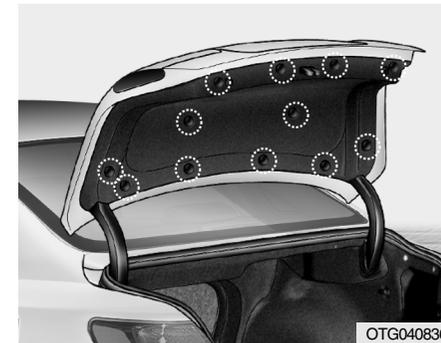
2. Afloje los tornillos de montaje del revestimiento de la puerta del maletero con un destornillador de estrella.
