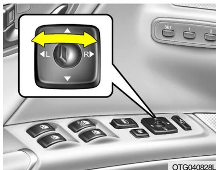
Los retrovisores exteriores pueden ser ajustados en cualquier dirección para facilitar una máxima visión hacia atrás. Los interruptores de los retrovisores exteriores controlan el ajuste de los retrovisores de las puertas de ambos lados.
