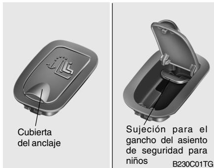
1. Abra la cubierta del anclaje de la correa situada en la bandeja detrás del asiento trasero.
