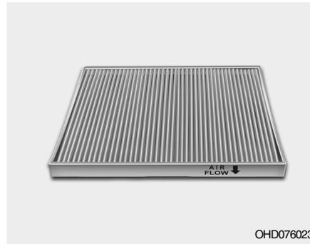
5. Sustituya el filtro de aire del climatizador.
