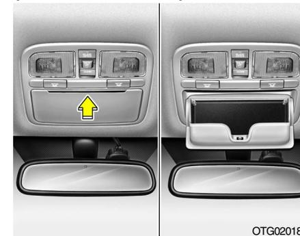
El compartimento para gafas está situado en la consola delantera del techo. Presione el extremo de la cubierta para abrir o cerrar el compartimento de gafas.
