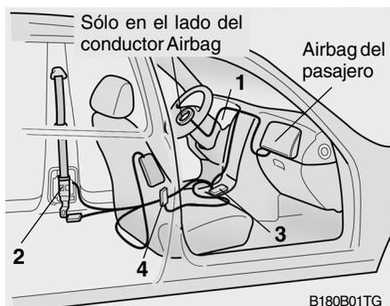
El sistema pretensor del cinturón de seguridad consta de los siguientes componentes, cuya situación se indica en el esquema.
