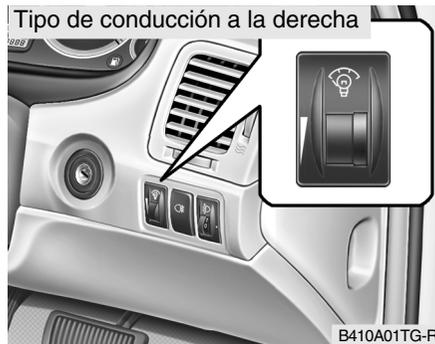
La intensidad de la luz de tablero se puede regular mediante el botón de regulación, haciéndola más brillante o menos intensa.
