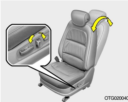
Tire de la parte superior del mando de control hacia delante o hacia atrás para reclinar el respaldo a la posición deseada. Suelte el mando de control y el respaldo permanecerá en esa posición.
