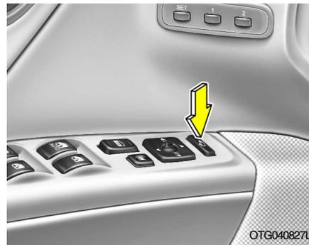
Los espejos izquierdo y derecho pueden doblarse pulsando el interruptor de doblado del espejo retrovisor exterior.
