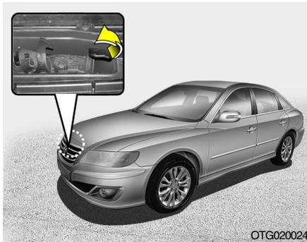
2. Tire de la palanca de bloqueo de seguridad hacia arriba y eleve el capó.
