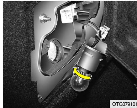
3. Para cambiar las luces intermitentes, extraiga la bombilla de su soporte e instale la nueva.
