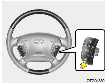
3. Pulsar el interruptor de control "-/SET" posición y soltarlo después de haber ajustado la velocidad del vehículo al valor deseado. Si se selecciona el botón "-/SET", el indicador luminoso "SET" en el cuadro de instrumentos se iluminará.
