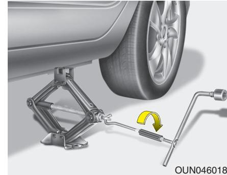
7. Coloque el gato delante o detrás en la posición correspondiente más cercana a la rueda que está cambiando. Sitúe el gato en los lugares designados a tal efecto bajo la carrocería. Las posiciones para colocar el gato son placas soldadas a la carrocería con dos pestañas y un punto elevado para graduar con el gato.
