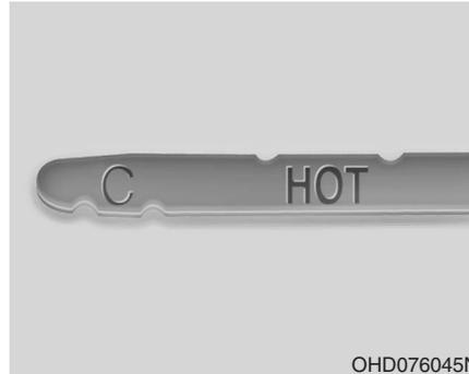
3. Compruebe que el nivel de líquido está en el margen "HOT" en el indicador de nivel. Si el líquido es inferior, añada el líquido específico por el orificio del llenado. Si el líquido es superior, drene el líquido específico por el orificio del drenaje.
