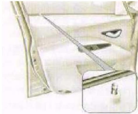
Podrá bloquear la puerta sin llave desde fuera del vehículo. Para bloquear la puerta sin llave, primero mueva el interruptor de encendido en el vehículo a "LOCK", saque la llave de la chapa y presione el control de operación de la puerta para cerrarla.
