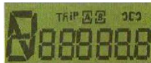
El subtotal de kilometraje se visualiza en la línea superior de LCD, la cual muestra el kilometraje total de marcha después de cero, del subtotal de kilometraje anterior o desde la última desconexión de la batería. Su ámbito de visualización es 0~999,9km, con precisión de 0,1 km, en
