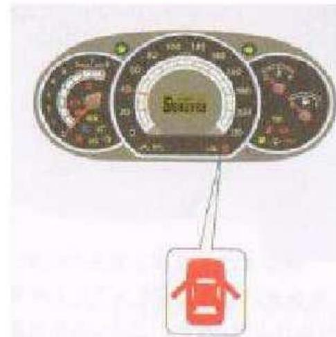
De existir una puerta mal cerrada, se iluminará el indicador de puerta abierta en el panel de instrumentos hasta que ésta sea bien cerrada.
