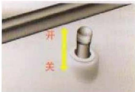
El botón de control de cierre de puertas del asiento de conductor y del acompañante controla el bloqueo de las cuatro puertas, presione hacia abajo el botón de control y se bloquearán las cerraduras de las cuatro puertas. Tire hacia arriba el botón de control, y se desbloquearán las cerraduras de las cuatro puertas. El botón de control de las cerraduras de las dos puertas traseras sólo controlan el bloqueo o desbloqueo de esa puerta del vehículo.
