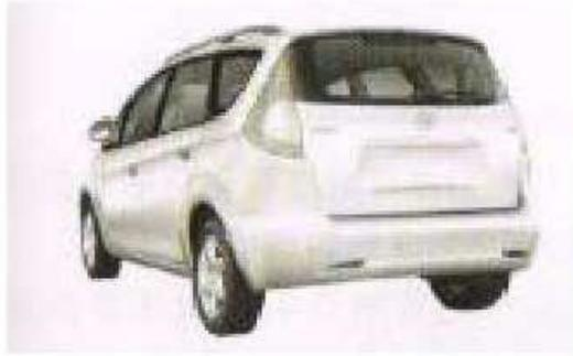
Después desbloquear el vehículo con la llave control remoto, tire hacia arriba la manilla de apertura de la puerta trasera y luego elévela para acceder al portaequipajes.
