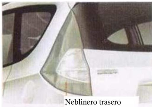
El neblinero trasero sirve para ser detectado por parte de los demás conductores en condiciones extremas de mala visibilidad.
