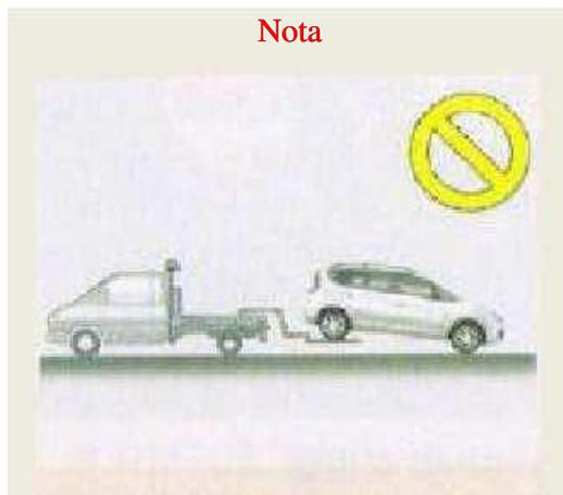
No es recomendable remolcar un vehículo con caja de cambios automática o combinada, por la parte trasera levantada y con las ruedas delanteras sobre el suelo. Producirá severos daños a la caja de cambios.
