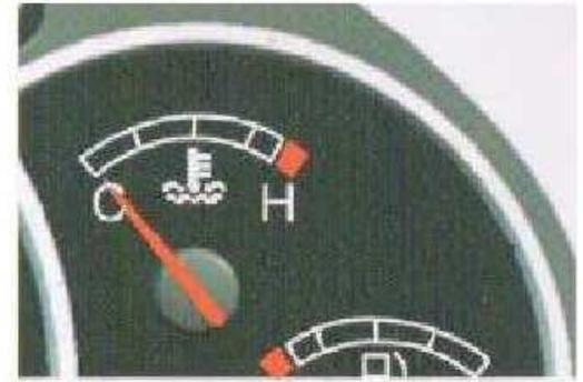
Sirve para visualizar la temperatura del refrigerante del motor, cuando la aguja entra en la zona roja, significa que la temperatura del refrigerante del motor excede al valor normal. En tal caso, deberá detener el vehículo para inspeccionarlo o contactarse con un servicio técnico autorizado por JAC.
