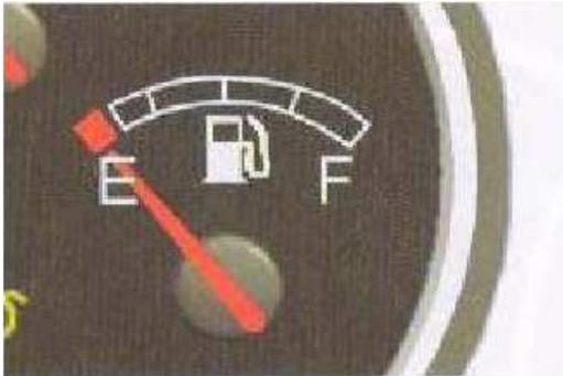
La aguja del marcador de combustible indica el volumen aproximado que existe en el tanque de combustible.
