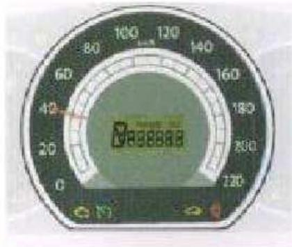
El velocímetro sirve para mostrar la velocidad del vehículo, unidad: kilómetros por hora (km/h).
