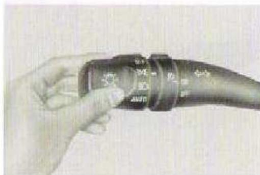
Utilice este comando combinado para señalar un viraje o cambio de pista a otros conductores y peatones.
