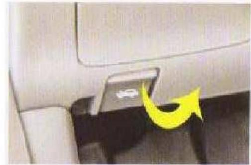
La palanca de apertura del capot se ubica a la izquierda, en la parte inferior del tablero de instrumentos. La operación para abrir y cerrar el capot es de la siguiente manera:
