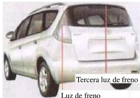
Las luces de freno sirven para avisar y alarmar a los conductores detrás de usted que su vehículo está frenando, a fin de que reduzcan su velocidad.
