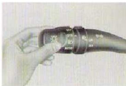
Gire el extremo del comando combinado para operar las luces. Cuando el interruptor se encuentra en la segunda posición, se encenderán las luces de posición, la luz de la patente y se
