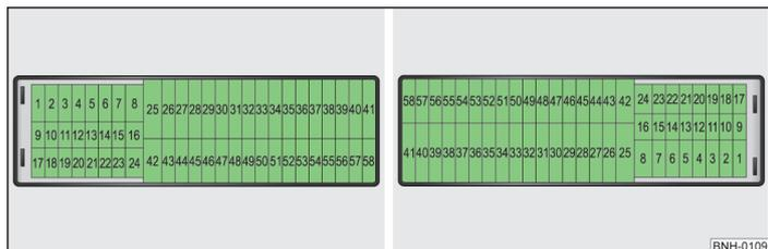
Fig. 166 Representación esquemática de la caja de fusibles para conducción a la izquierda/derecha
