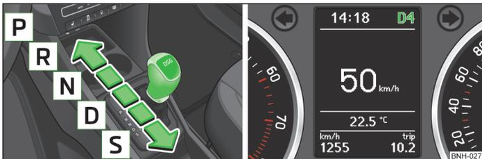
Fig. 93 Palanca selectora / indicador de pantalla
