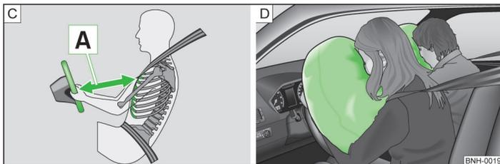
Fig. 120 Distancia de seguridad con respecto al volante / airbags rellenos de gas
