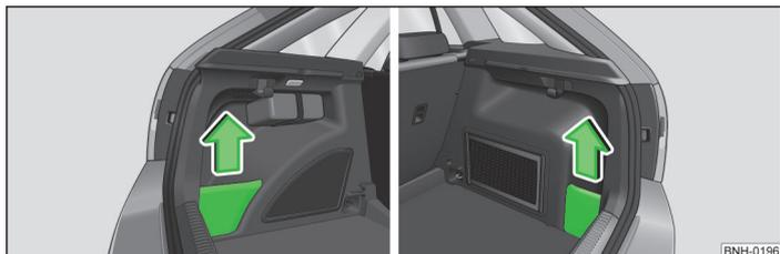
Fig. 66 Quitar la cubierta del compartimento guardaobjetos (Rapid Spaceback): a izquierda/derecha
