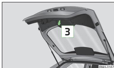
Fig. 19 Tirador en el revestimiento interior de la tapa del maletero
