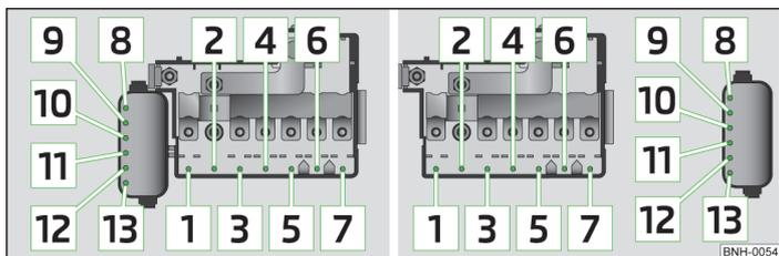
Fig. 169 Representación esquemática de la caja de fusibles en el vano motor: Variante 1 / Variante 2
