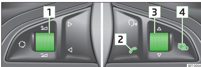
Fig. 81 Volante multifunción: teclas de manejo del teléfono
