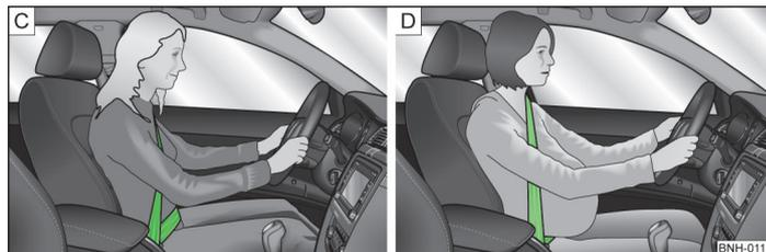
Fig. 117 Colocación de la banda del cinturón en la zona de los hombros y la pelvis/colocación de la banda del cinturón en el caso de mujeres embarazadas
