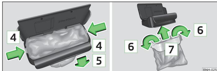
Fig. 52 Sustituir bolsa
