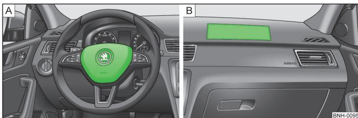
Fig. 119 Airbag del conductor en el volante / airbag del acompañante en el tablero de instrumentos
