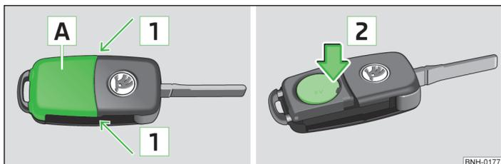
Fig. 159 Desmontar la tapa / extraer la pila
