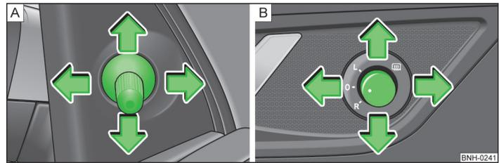
Fig. 34 Puerta delantera - botón giratorio para los espejos retrovisores: mecánico/eléctrico
