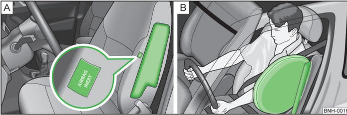
Fig. 121 Lugar de montaje del airbag lateral en el asiento del conductor / airbag lateral lleno de gas
