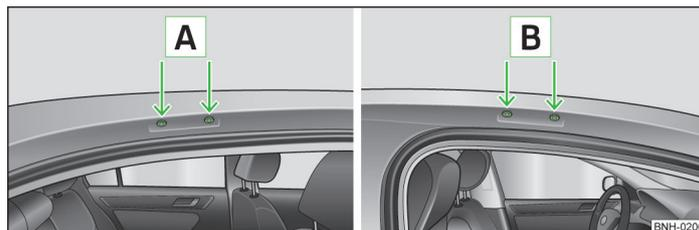
Fig. 76 Puntos de fijación para soportes básicos
