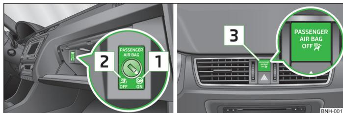
Fig. 123 Conmutador de llave para el airbag lateral del acompañante / testigo para la conexión/desconexión del airbag delantero del acompañante
