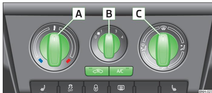
Fig. 79 Sistema de aire acondicionado: elementos de manejo
