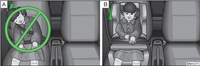
Fig. 126 Un niño mal asegurado en una posición de asiento errónea está en peligro por el airbag lateral / un niño asegurado correctamente con un asiento infantil
