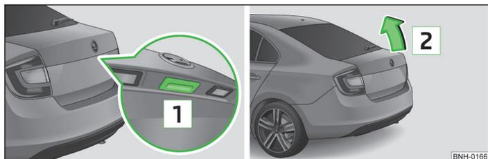
Fig. 18 Empuñadura de la tapa del maletero / abrir la tapa del maletero
