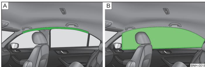
Fig. 122 Lugar de montaje del airbag de cabeza / airbag de cabeza relleno de gas
