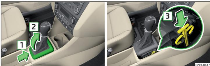
Fig. 146 Desbloqueo de emergencia de la palanca selectora
