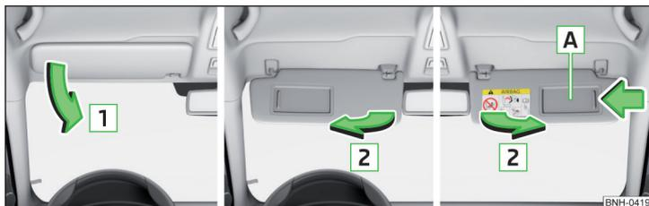
Fig. 47 Bajar visera / Girar visera hacia la puerta y colocar cubierta de espejo
