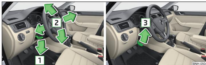
Fig. 2 Ajustar la posición del volante
