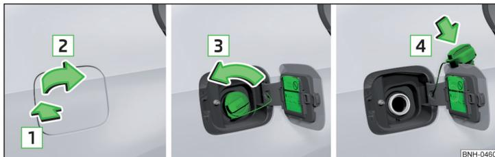
Fig. 116 Abrir la tapa del depósito/ desenroscar el cierre del depósito/ colocar el cierre del depósito en la tapa del depósito
