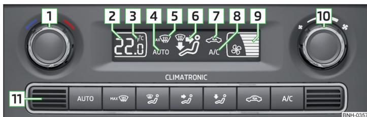
Fig. 86 Elementos de mando del Climatronic
