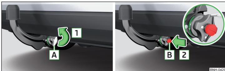
Fig. 110 Retire la tapa de la cerradura/introduzca la llave en la cerradura
