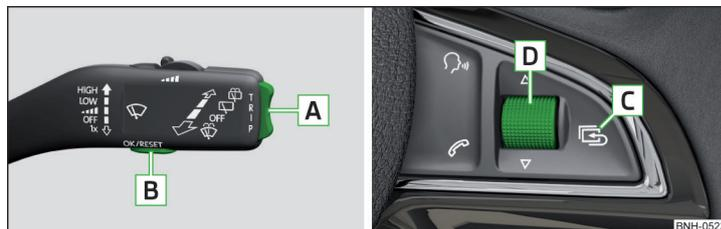
Fig. 26 Teclas/rueda de ajuste: en la palanca de mando / en el volante multifunción
