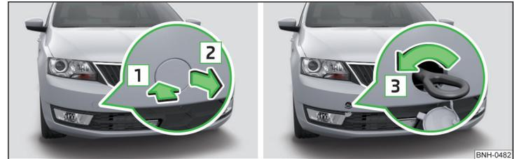
Fig. 141 **desmontaje de la caperuza protectora / montaje de la argolla de remolque**
