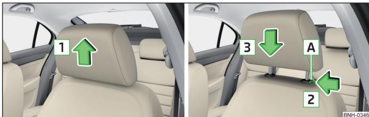
Fig. 52 Reposacabezas: mover hacia arriba / hacia abajo
