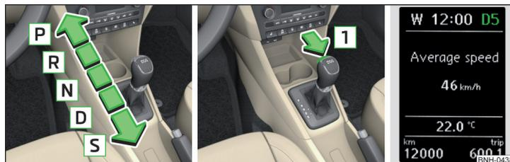
Fig. 94 Palanca selectora / tecla de bloqueo / indicador de pantalla
