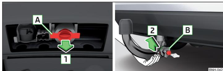
Fig. 107 Extraer la caperuza protectora de la cavidad de alojamiento / colocar la barra de cabeza esférica
