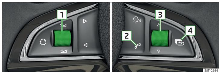
Fig. 87 Volante multifunción: teclas de manejo del teléfono
