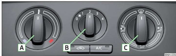
Fig. 85 Elementos de mando del aire acondicionado
