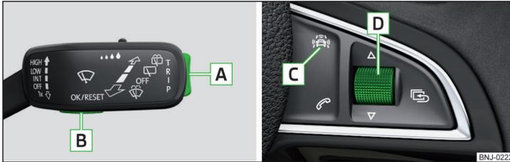
Fig. 134 Teclas/Rueda de ajuste: en la palanca de mando / en el volante multifunción
