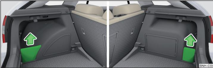
Fig. 96 Retirar la cubierta del compartimento guardaobjetos izquierda/derecha
