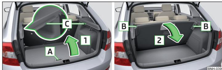
Fig. 103 Levantar/bajar el suelo de carga variable
