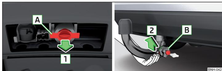
Fig. 141 Extraer la caperuza protectora de la cavidad de alojamiento / colocar la barra de cabeza esférica
