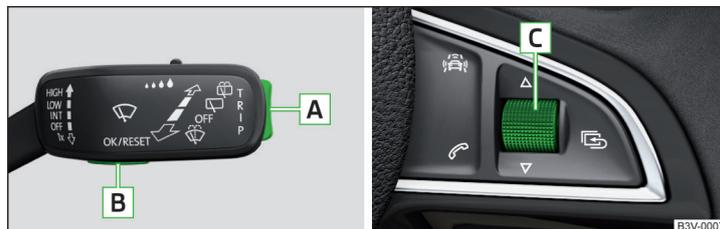
Fig. 28 Teclas/Rueda de ajuste: en la palanca de mando / en el volante multifunción
