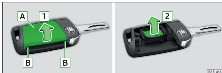
Fig. 177 Desmontar la tapa / extraer la pila
