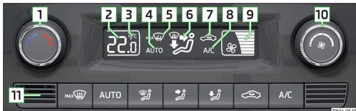
Fig. 108 Elementos de mando del Climatronic
