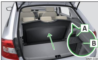
Fig. 95 Cubierta del maletero guardada detrás de los asientos traseros
