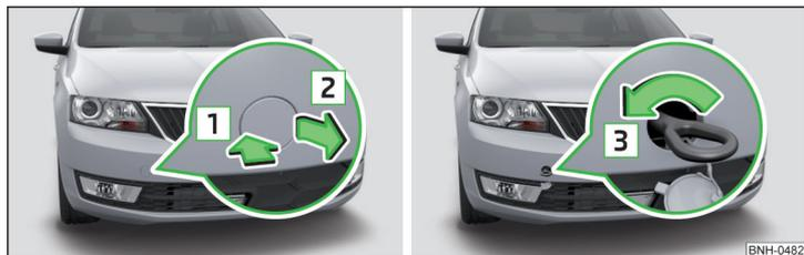
Fig. 175 desmontaje de la caperuza protectora / montaje de la argolla de remolque
