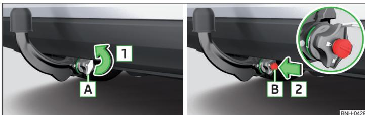
Fig. 144 Retire la tapa de la cerradura/introduzca la llave en la cerradura
