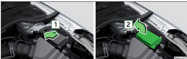
Fig. 186 Tapa de la caja de fusibles - Variante 2
