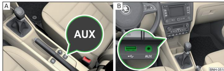
Fig. 84 Lugares de montaje de las entradas: AUX / MDI (AUX y USB)
