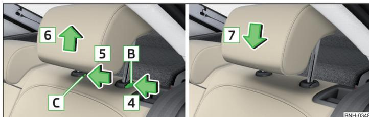
Fig. 62 Reposacabezas traseros: desmontar/montar
