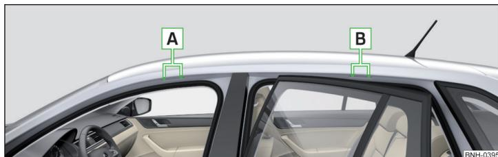
Fig. 105 Puntos de fijación
