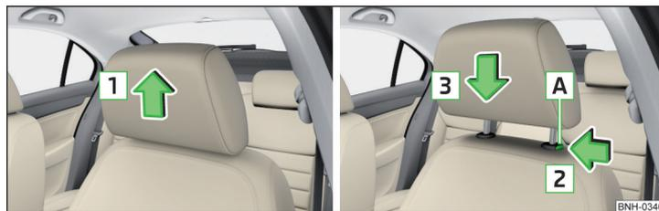
Fig. 60 Reposacabezas: mover hacia arriba / hacia abajo
