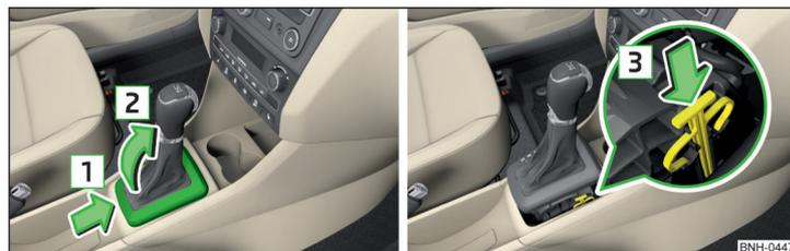
Fig. 180 Desbloqueo de emergencia de la palanca selectora
