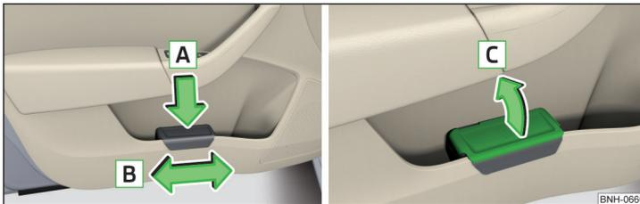
Fig. 69 Cubo de basura: colocar y mover / abrir
