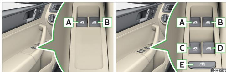
Fig. 38 Teclas de los elevalunas: Variante 1 / Variante 2
