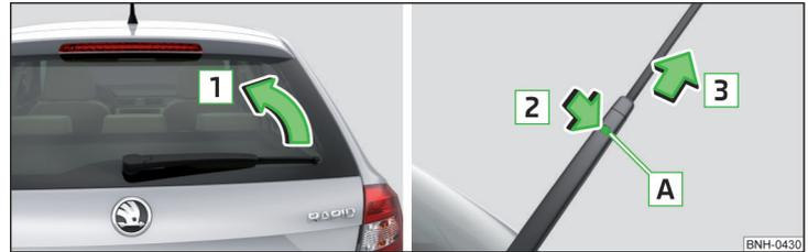
Fig. 183 Reemplazar la escobilla limpiacristales de la luna trasera
