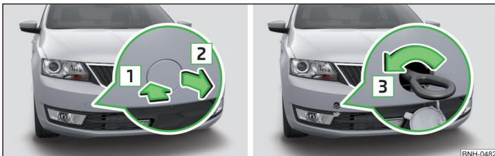
Fig. 174 Retirar la caperuza / instalar la argolla de remolque
