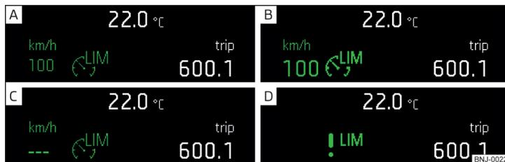
Fig. 126 Pantalla MAXI DOT: Ejemplos de las visualizaciones de estado del dispositivo de limitación de velocidad
