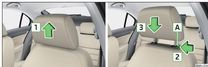
Fig. 58 Ajustar la altura del reposacabezas
