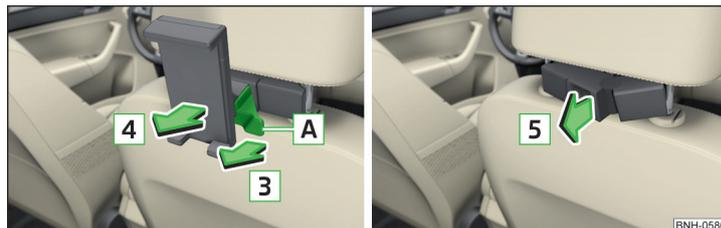
Fig. 83 Retirar: Soporte / adaptador
