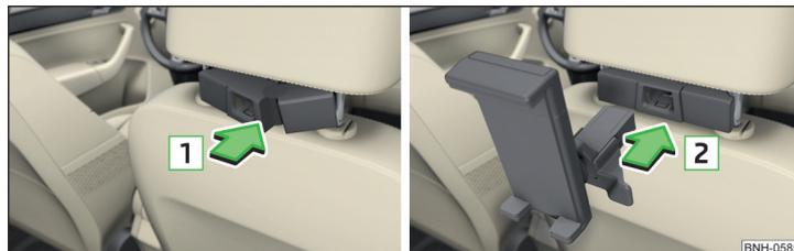
Fig. 82 Introducir: Adaptador / soporte
