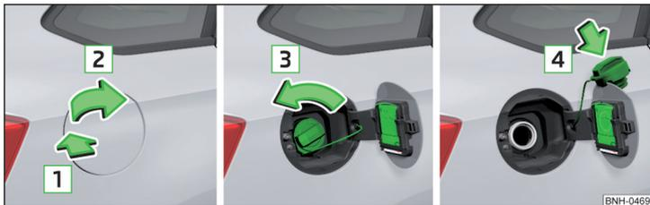
Fig. 150 Abrir la tapa del depósito/ desenroscar el cierre del depósito/ colocar el cierre del depósito en la tapa del depósito
