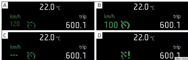
Fig. 123 Pantalla MAXI DOT: ejemplos para el indicador de estado del GRA
