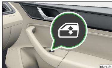
Fig. 39 Tecla del elevalunas eléctrico
