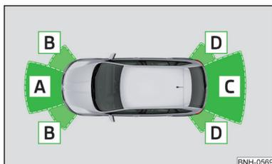
Fig. 117 Zonas parpadeadas y alcance de los sensores
