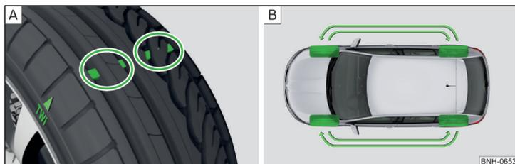
Fig. 159 Indicador de desgaste de los neumáticos / cambio de las ruedas
