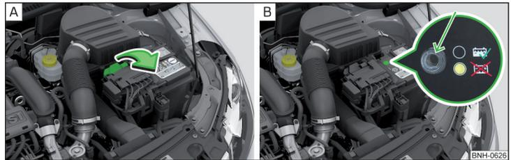
Fig. 157 Batería del vehículo: Abrir la cubierta / Indicador de nivel de ácido
