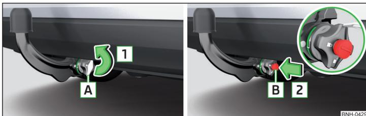
Fig. 142 Retire la tapa de la cerradura/introduzca la llave en la cerradura
