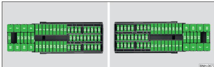
Fig. 186 Fusibles: Dirección a la izquierda / Dirección a la derecha
