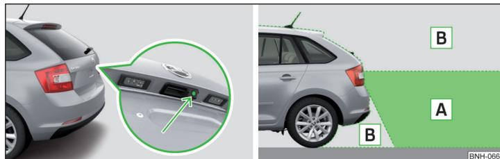
Fig. 121 Lugar de instalación de la cámara / área parpadeado detrás del vehículo
