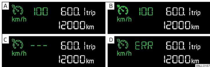
Fig. 124 Pantalla de segmentos: ejemplos para el indicador de estado del GRA
