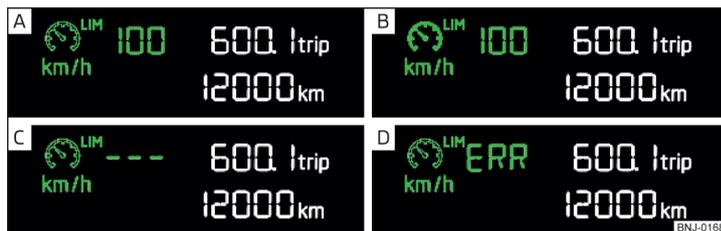
Fig. 127 Pantalla de segmentos: Ejemplos de las visualizaciones de estado del dispositivo de limitación de velocidad
