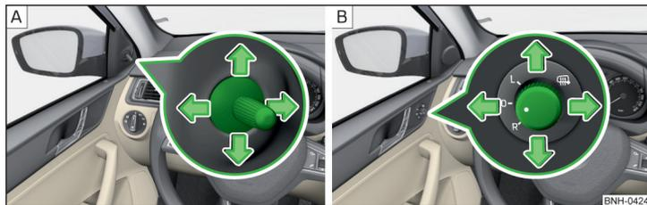
Fig. 53 Operación del retrovisor: mecánico/eléctrico
