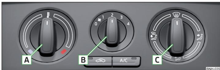
Fig. 101 Elementos de mando de la calefacción/aire acondicionado
