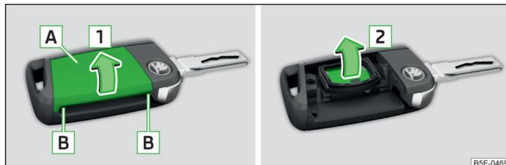
Fig. 176 Desmontar la tapa / extraer la pila
