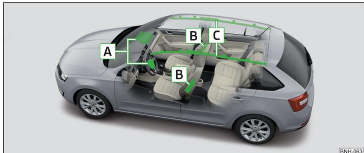
Fig. 7 Lugares de instalación del airbag
