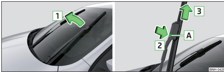
Fig. 182 Cambiar la escobilla limpiacristales del parabrisas
