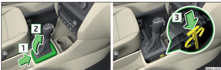
Fig. 180 Retirar la tapa / desbloquear la palanca selectora
