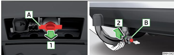
Fig. 139 Extraer la caperuza protectora de la cavidad de alojamiento / colocar la barra de cabeza esférica
