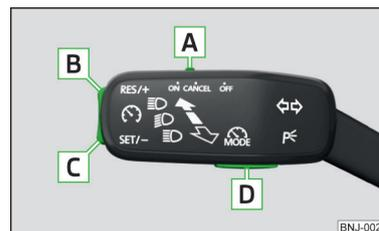
Fig. 125 elementos de manejo del regulador de velocidad
