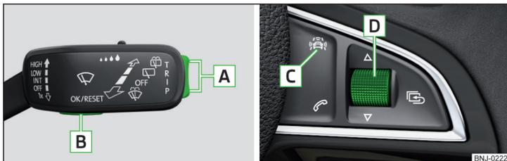
Fig. 208 Teclas/Rueda de ajuste: en la palanca de mando / en el volante multifunción
