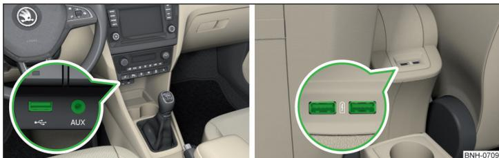
Fig. 78 Entrada USB y AUX adelante / Entradas USB atrás
