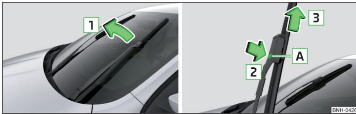
Fig. 256 Cambiar la escobilla limpiacristales del parabrisas
