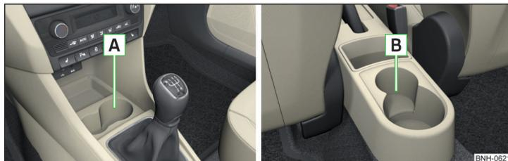
Fig. 80 Soporte de bebidas delantero/trasero
