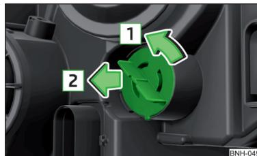
Fig. 268 Cambiar la bombilla para luz intermitente delantera
