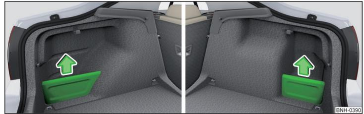
Fig. 107 Retirar la cubierta del compartimento guardaobjetos izquierda/derecha
