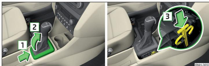
Fig. 254 Retirar la tapa / desbloquear la palanca selectora
