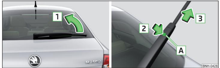
Fig. 257 Reemplazar la escobilla limpiacristales de la luna trasera
