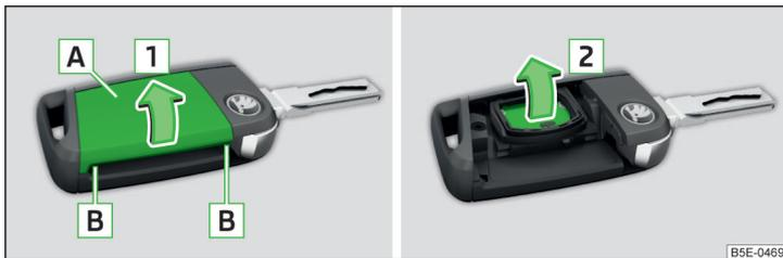
Fig. 250 Abrir la tapa / Extraer la pila
