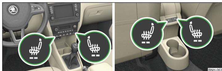
Fig. 74 Teclas para la calefacción de asientos delanteros/asientos posteriores
