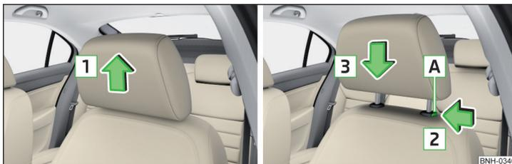
Fig. 71 Ajustar la altura del reposacabezas
