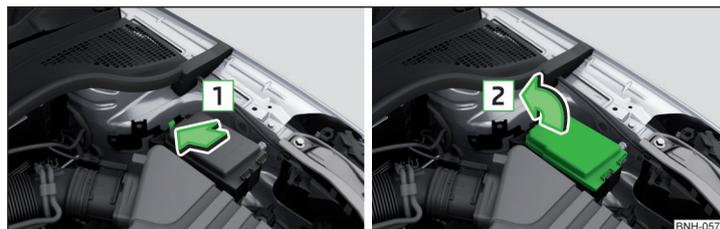
Fig. 262 Tapa de la caja de fusibles - Variante 2
