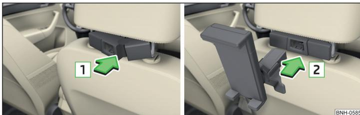
Fig. 96 Introducir: Adaptador / soporte
