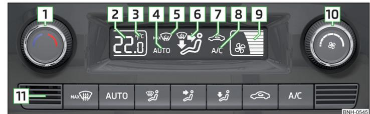
Fig. 111 Elementos de mando del Climatronic
