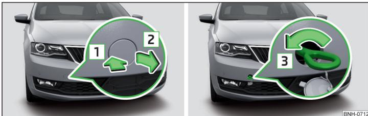
Fig. 248 Retirar la caperuza / instalar la argolla de remolque
