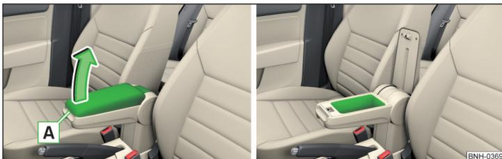
Fig. 85 Abrir el compartimento guardaobjetos/Compartimento guardaobjetos
