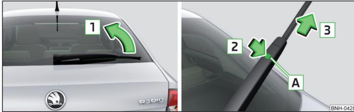
Fig. 256 Reemplazar la escobilla limpiacristales de la luna trasera
