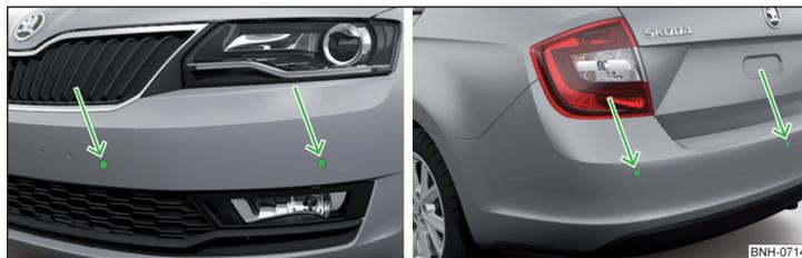
Fig. 193 Lugar de instalación de los sensores del lado izquierdo del vehículo: delantero / trasero
