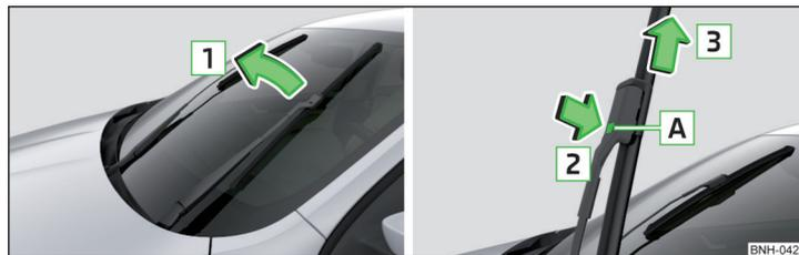
Fig. 255 Cambiar la escobilla limpiacristales del parabrisas
