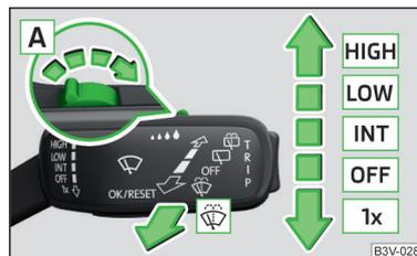
Fig. 63 Manejo de la instalación de los limpiaparabrisas y del lavado automático adelante
