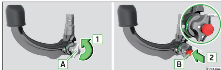
Fig. 212 Retire la tapa de la cerradura/introduzca la llave en la cerradura
