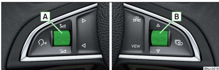
Fig. 39 Teclas/ruedas de ajuste en el volante multifuncional
