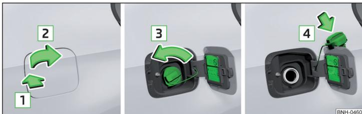
Fig. 224 Abrir la tapa del depósito/ desenroscar el cierre del depósito/ colocar el cierre del depósito en la tapa del depósito
