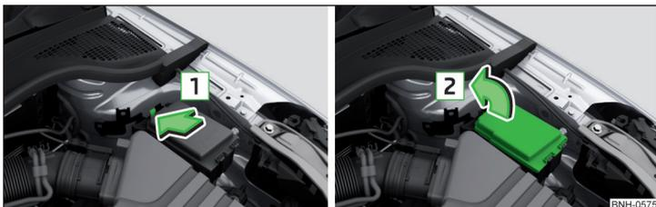
Fig. 261 Tapa de la caja de fusibles - Variante 2
