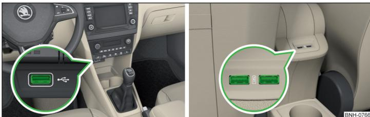
Fig. 78 Entrada USB delantera / Entradas USB traseras
