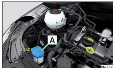
Fig. 227 depósito de agua del lavacrystal
