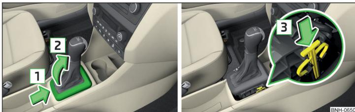
Fig. 253 Retirar la tapa / desbloquear la palanca selectora
