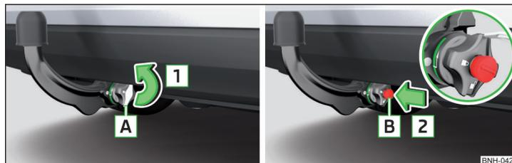
Fig. 218 Retire la tapa de la cerradura/introduzca la llave en la cerradura
