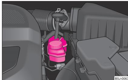
**Fig. 160 Vano motor: Depósito del líquido de frenos**
