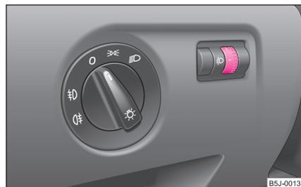
Fig. 34 Cuadro de interruptores: Regulación del alcance luminoso de los faros
