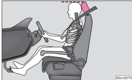
Fig. 117 El ajuste correcto del reposacabezas del conductor
