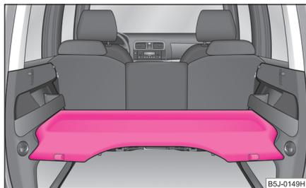
Fig. 64 Cubierta del maletero en la posición inferior
