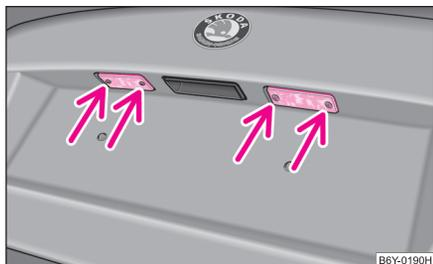
Fig. 190 Desmontar la luz de la matrícula
