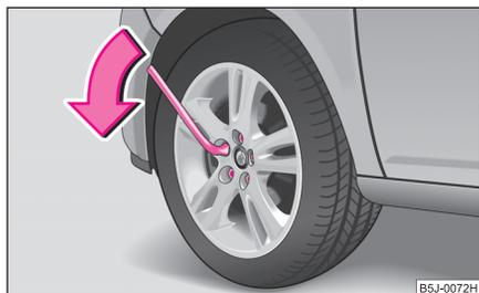
Fig. 172 Cambio de rueda: Aflojar los tornillos de rueda
