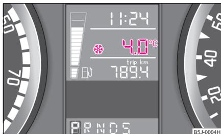
Fig. 7 Indicador multifunción: la temperatura exterior
