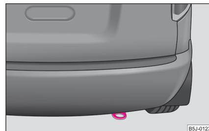
Fig. 178 Argolla de remolque trasera
