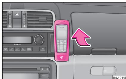
Fig. 113 Preparación universal para el teléfono
