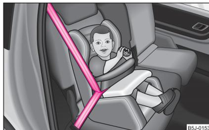
Fig. 139 Asiento infantil instalado en dirección de la marcha con mesa de seguridad del grupo 1 en el asiento trasero
