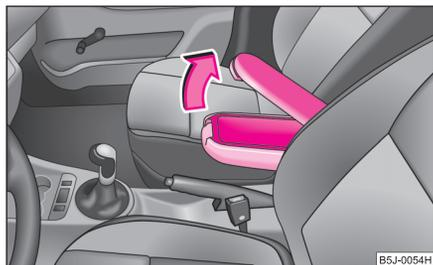
Fig. 86 Abrir el compartimento guardaobjetos
