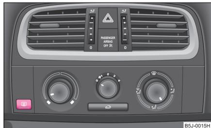
Fig. 39 Conmutador para la calefacción de luneta
