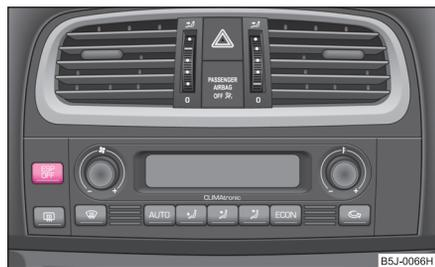
Fig. 145 Interruptor del ESP
