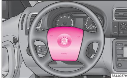
Fig. 125 Airbag del conductor en el volante
