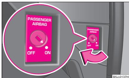
Fig. 133 Conmutador para el/los airbag(s) del acompañante)
