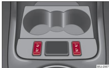
Fig. 63 Conmutador basculante: Calefacción de asiento delantero
