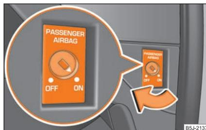
Fig. 153 Conmutador para el/los airbag(s) del acompañante)
