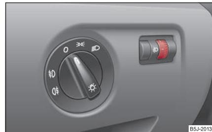
Fig. 49 Cuadro de interruptores: Regulación del alcance luminoso de los faros
