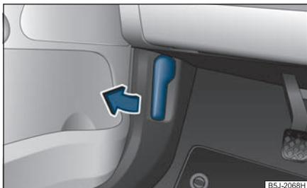
Fig. 174 Palanca de desbloqueo para el capó
