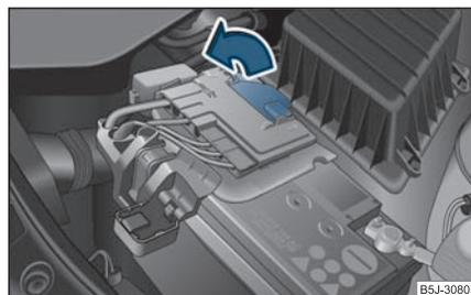
**Fig. 182** Batería: Levantar la tapa (cambio manual)
