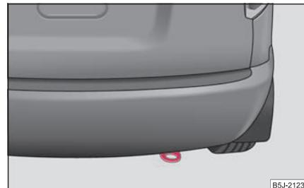
Fig. 198 Argolla de remolque trasera
