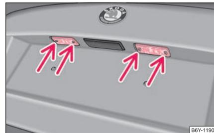
Fig. 211 Desmontar la luz de la matricula
