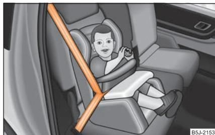
Fig. 159 Asiento infantil instalado en dirección de la marcha con mesa de seguridad del grupo 1 en el asiento trasero
