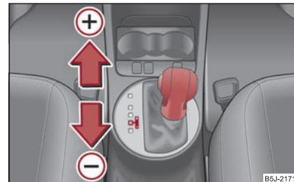
Fig. 127 Palanca selectora: cambio manual
