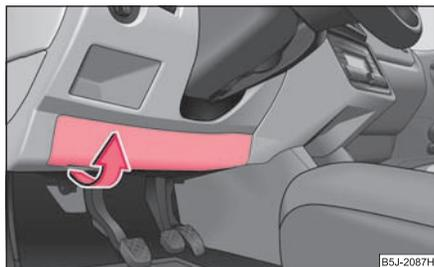
Fig. 199 Lado inferior del tablero de instrumentos: tapa de seguridad
