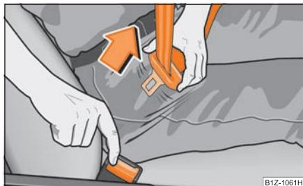
Fig. 144 Retirar la lengüeta del cierre del cinturón
