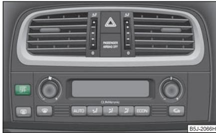
Fig. 165 Interruptor del ESP
