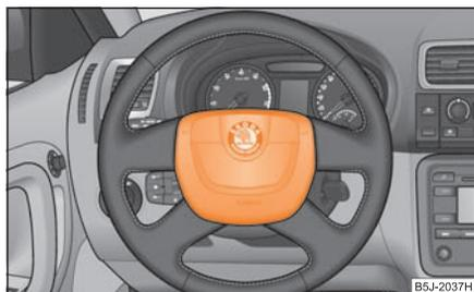
Fig. 145 Airbag del conductor en el volante
