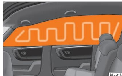
Fig. 152 Airbag de cabeza relleno de gas
