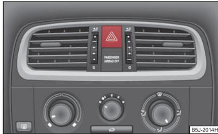
Fig. 50 Cuadro de interruptores: Interruptor para el sistema de intermitentes simultáneos
