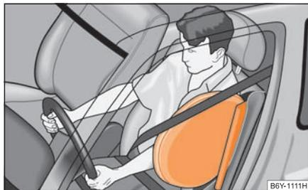
Fig. 150 Airbag lateral activado
