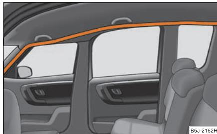
Fig. 151 Lugar de montaje del airbag de cortinilla
