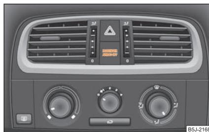
Fig. 154 Testigo de la desactivación del airbag de acompañante
