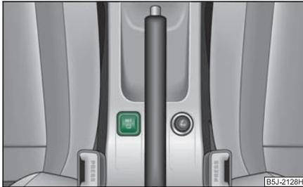
**Fig. 167 Tecla para ajustar el valor de control de la presión de inflado de los neumáticos**
