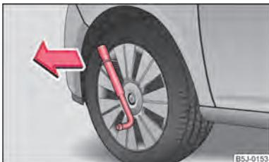
Fig. 135 Desmontar el tapacubos integral
