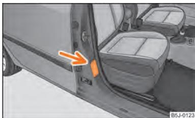
Fig. 105 Adhesivo en el montante central de la carrocería, lado del acompañante
