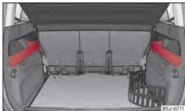
Fig. 71 Compartimentos guardaobjetos en el revestimiento lateral
