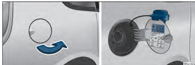
Fig. 120 Parte trasera del vehículo, lado derecho: Tapa del depósito/tapa del depósito con el tapón desenroscado
