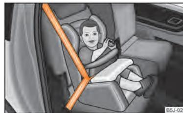
Fig. 108 Asiento infantil instalado en dirección de la marcha con mesa de seguridad del grupo 1 en el asiento trasero
