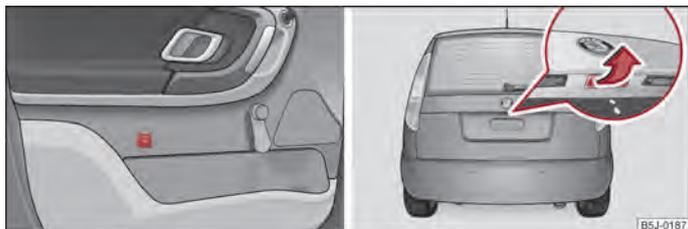
Fig. 15 Desbloquear la tapa del maletero/asidero de la tapa del maletero
