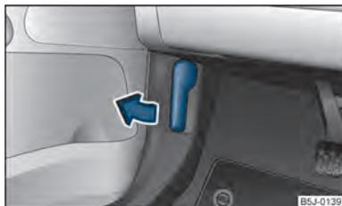
Fig. 121 Palanca para abrir la tapa del maletero
