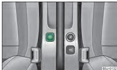
Fig. 114 Tecla para ajustar el valor de control de la presión de inflado de los neumáticos
