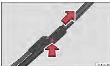
Fig. 31 Escobilla para el parabrisas
