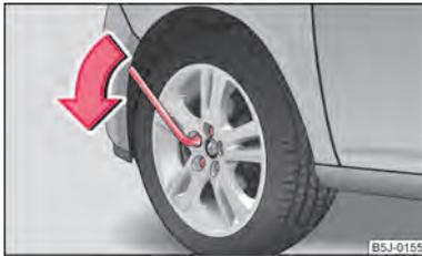
Fig. 137 : Aflojar los tornillos de rueda
