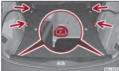
Fig. 162 Compartimento de carga: Argollas de sujeción
