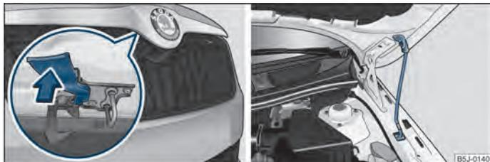
Fig. 122 Rejilla del radiador: Palanca de seguridad/seguro del capó con la varilla de apoyo
