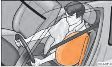
Fig. 101 Airbag lateral lleno de gas
