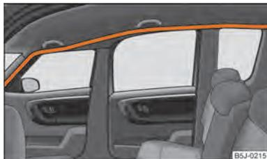
**Fig. 102** Lugar de montaje del airbag de cortinilla
