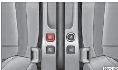
Fig. 83 Consola central: Tecla del sistema de ARRANQUE-PARADA
