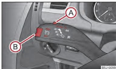
Fig. 82 Palanca de mando: Balancín y conmutador del sistema regulador de la velocidad
