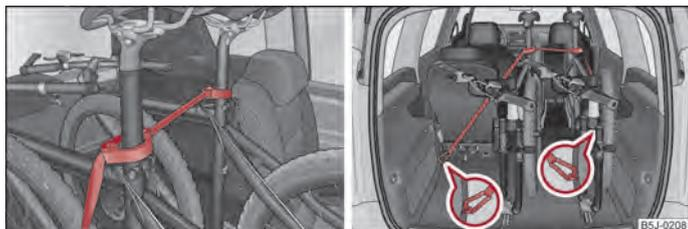
Fig. 56 Fijación de las bicicletas con abrazaderas/fijación de las bicicletas con una cuerda
