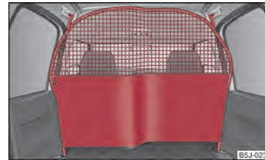
Fig. 163 Panel separador de seguridad ajustable
