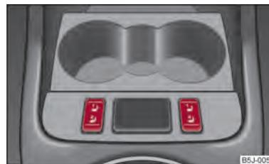
Fig. 36 Conmutador basculante: Calefacción de asiento delantero
