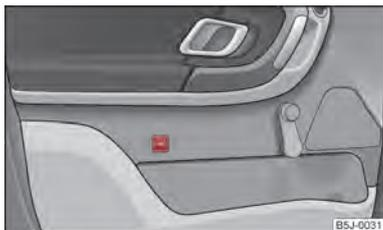
**Fig. 18** Tecla para la vigilancia del habitáculo y el control de la protección contra remolcado
