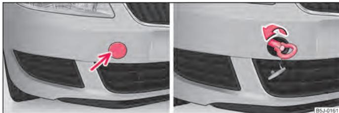
Fig. 144 Paragolpes delantero: Cubierta/montaje de la argolla de remolque
