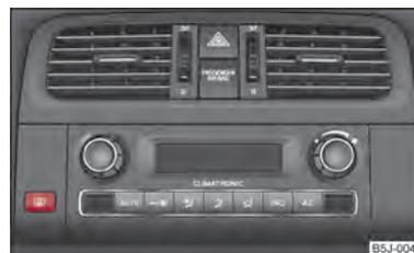
Fig. 28 Conmutador para la calefacción de luneta
