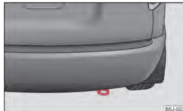
Fig. 145 Argolla de remolque trasera
