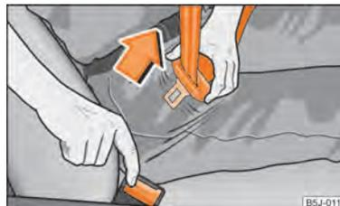
Fig. 96 Retirar la lengüeta del cierre del cinturón
