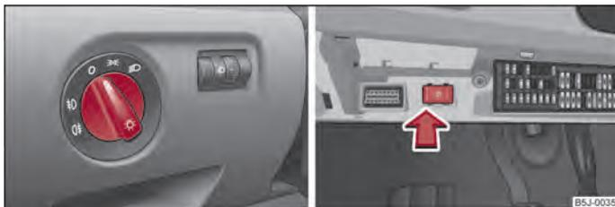
Fig. 21 Cuadro de interruptores: Conmutador de luz/conmutador de marcha diurna
