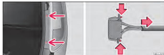
Fig. 160 Desmontar la unidad de luces traseras/separar el conector
