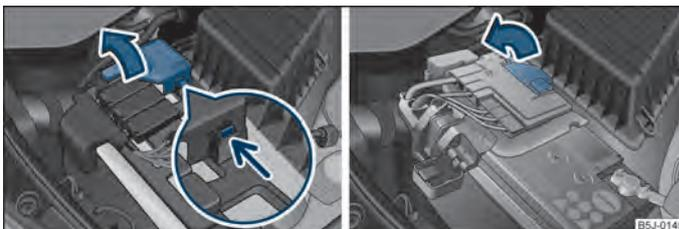
Fig. 127 Batería: Levantar la tapa (cambio automático)/(cambio manual)
