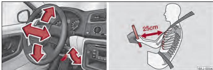
Fig. 77 Volante regulable: Palanca debajo de la columna de dirección/distancia segura desde el volante
