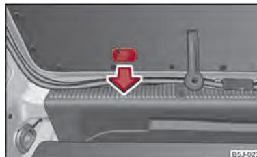
Fig. 166 Desbloqueo de emergencia del portón del compartimiento de carga
