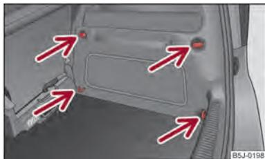
Fig. 44 Maletero: Argollas de amarre y elementos de fijación
