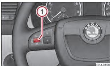
Fig. 90 Volante multifunción: Manejo del teléfono
