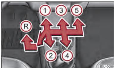
Fig. 79 Esquema de cambio de marchas en vehículos con cambio manual de 5 marchas
