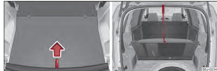
Fig. 164 Lazo para levantar el piso de carga/Sujeción del piso de carga por medio de un gancho de plástico
