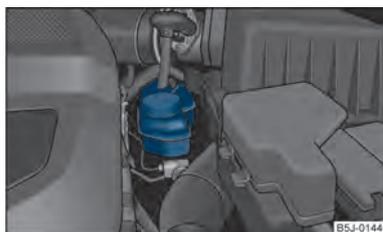
Fig. 126 Vano motor: Depósito del líquido de frenos
