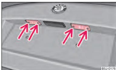
Fig. 159 Desmontar la luz de la matrícula
