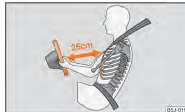
Fig. 99 Distancia de seguridad con respecto al volante
