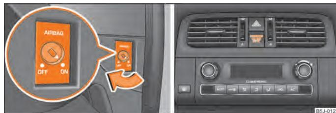
Fig. 104 Conmutador para airbag frontal del acompañante/testigo para desconexión de airbag del acompañante
