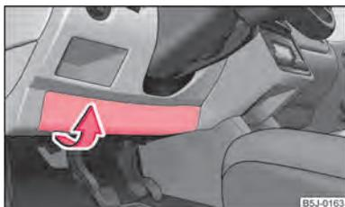
Fig. 146 Lado inferior del tablero de instrumentos: tapa de seguridad
