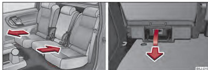
Fig. 37 Desbloqueo delante/detrás
