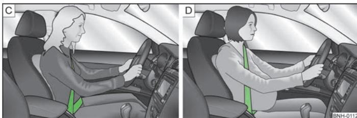
Fig. 97 Colocación de la banda del cinturón en la zona de los hombros y la pelvis/colocación de la banda del cinturón en el caso de mujeres embarazadas
