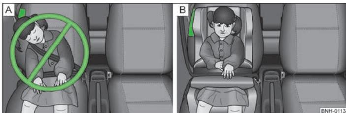
Fig. 105 Un niño asegurado incorrectamente en una posición de asiento errónea - en peligro a causa del airbag lateral/Un niño asegurado correctamente con un asiento infantil
