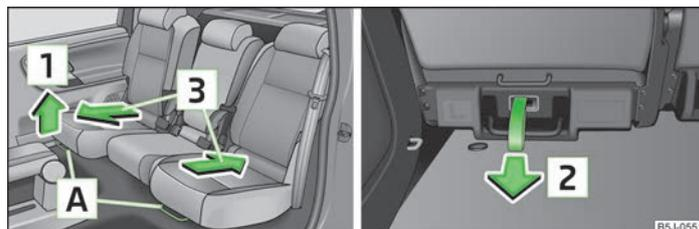
Fig. 38 Desbloqueo delante/detrás
