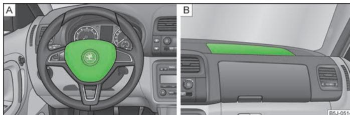
Fig. 99 Airbag delantero del conductor en el volante/airbag delantero del acompañante en el salpicadero
