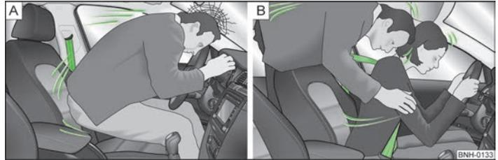
Fig. 95 Conductor con el cinturón de seguridad no abrochado/Acompañante con el cinturón de seguridad no abrochado en el asiento trasero
