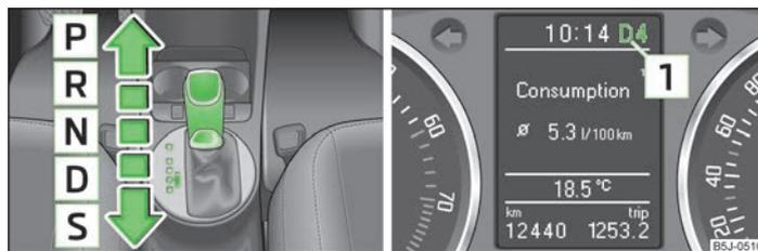
Fig. 86 Palanca selectora/pantalla informativa: Posiciones de la palanca selectora
