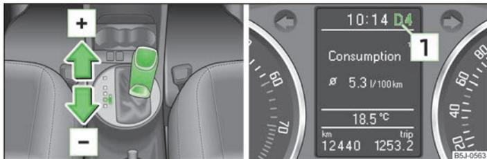
Fig. 87 Palanca selectora/pantalla informativa: Posiciones de la palanca selectora
