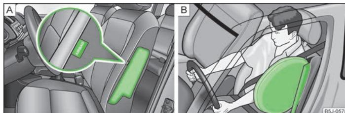
Fig. 101 Lugar de montaje del airbag lateral en el asiento del conductor/Airbag lateral lleno de gas
