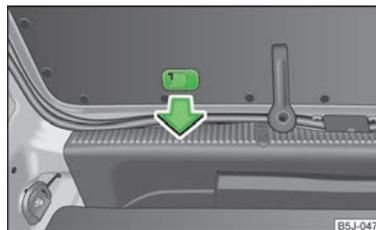
Fig. 158 Desbloqueo de emergencia del portón del compartimento de carga
