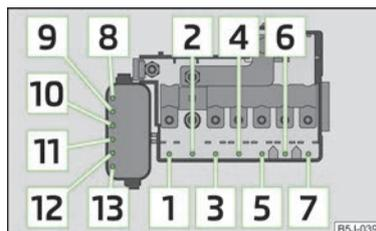
Fig. 142 Representación esquemática de la caja de fusibles en el vano motor
