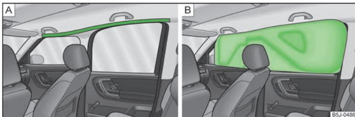
Fig. 102 Lugar de montaje del airbag de cabeza/Airbag de cabeza relleno de gas
