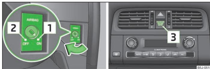
Fig. 103 Conmutador de llave para el airbag lateral del acompañante/Testigo para la desconexión del airbag delantero del acompañante
